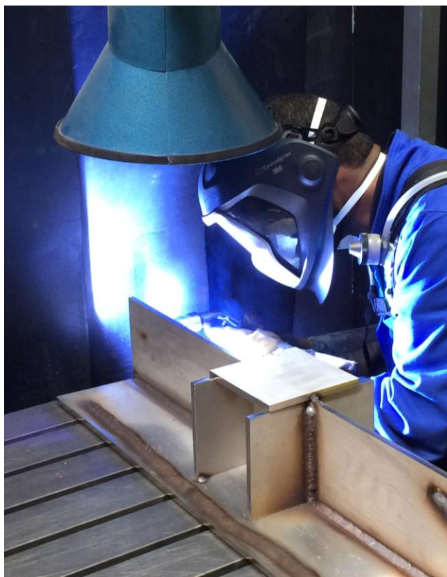
Bild 1: Beispiel Gefahrstofffreisetzung beim Schweißen
