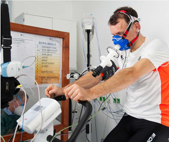
Abb. 1: Spiroergometrische Belastungsuntersuchung. Das zu testende Maskenmaterial befindet sich im Aufnahmesystem vor der blauen Spiroergometrie-Maske.
