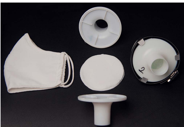
Abb. 2: Aufnahmesystem für das Maskenmaterial vor dem Zusammenbau
