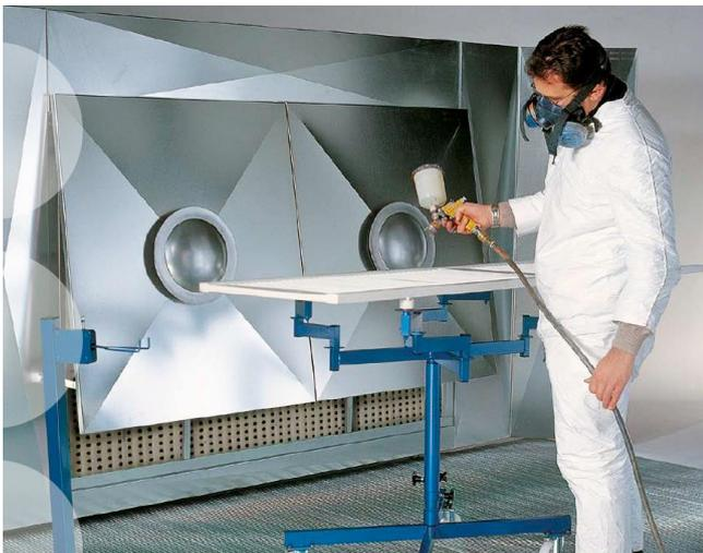
Bild 1: Manuelles Spritzlackieren an einer Absaugwand mit Trockenabscheidung
