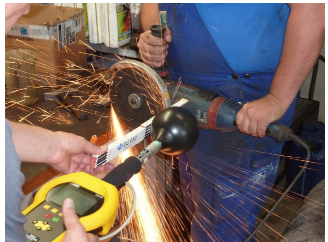
Messung elektromagnetischer Felder an einem Winkelschleifer (Bild: IFA)
