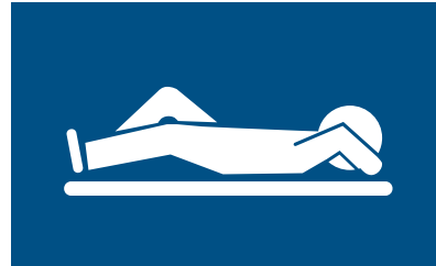
Abb. 9 Hinweiszeichen Ruheraum Das Hinweiszeichen ist auf blauem Grund mit weißem Bildzeichen ausgeführt. Die Maße betragen in der Höhe \geq 52 mm und in der Breite \geq 105 mm.
