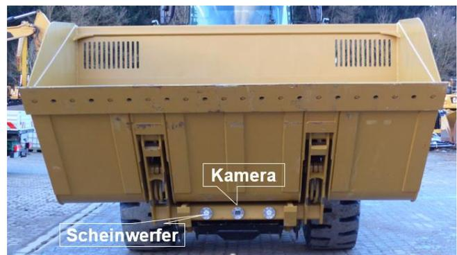
Bild 5: Kamera unterhalb der Ladeschaufel
