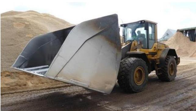
Bild 1: Radlader mit Leichtgutschaufel
