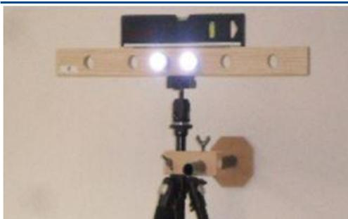
**Bild 18:** Sichtfeldmessgerät, dessen Messbalken in der Höhe und horizontal verstellbar sowie drehbar ist. Die Bohrungen für Lampen mit 65 mm, 205 mm und 405 mm Abstand.
