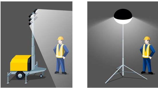
Abbildung 1: Beispiele für mobile Lichtmasten. Links: Lichtgiraffe. Rechts: Powermoon.
