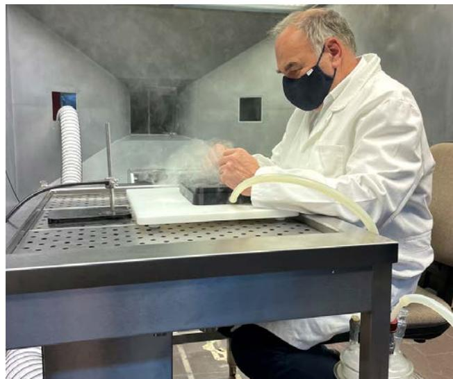
Strömungssimulation an einem abgesaugten Pathologietisch mithilfe von Glykolnebel. Entsprechend den Corona-Schutzauflagen trägt der Proband einen Mund-Nasen-Schutz.
