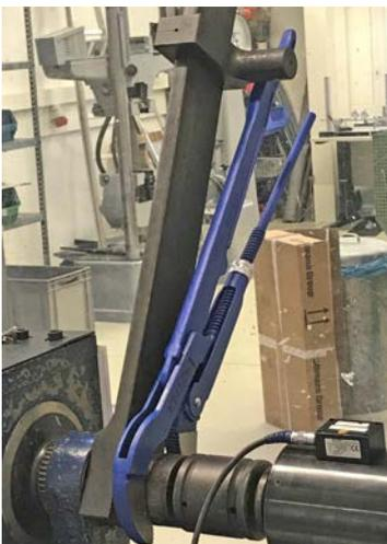
Drehmomentprüfung einer Eckrohrzange.
