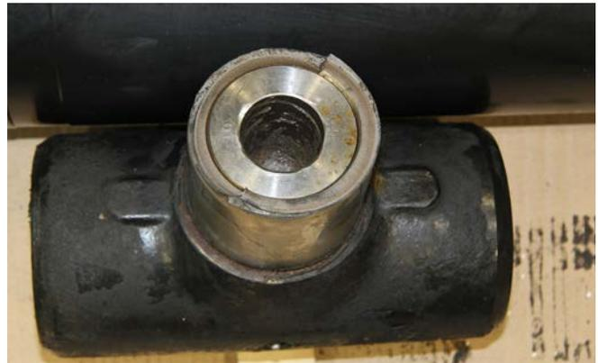
Kolbenstangenaufnahmekopf mit hülsenförmigen Bruchstück der Kolbenstange.
