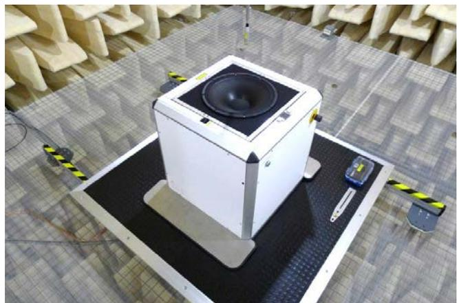
Prüfeinrichtung für Schallpegelmesser im Vollschallschluckraum.
