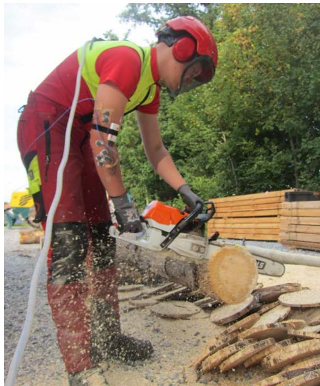
Hand-Arm-Vibration: Messung der Vibrationsbelastung bei Arbeiten mit Kettensägen.
