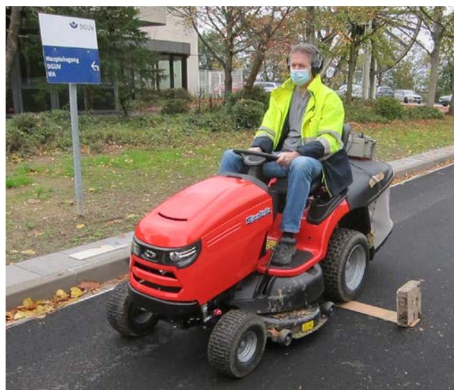
Ganzkörper-Vibration: IFA Teststrecke Vibration.
