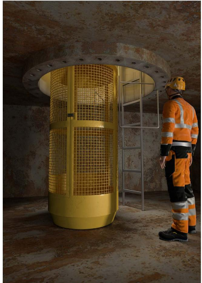
Abb. 15 Personenförderkorb für das Schachtrohr
