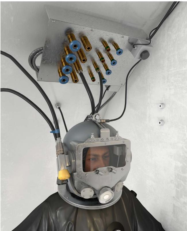
Abb. 17 Zertifizierte Tauchausrüstung für Taucharbeiten in Bentonitsuspension
