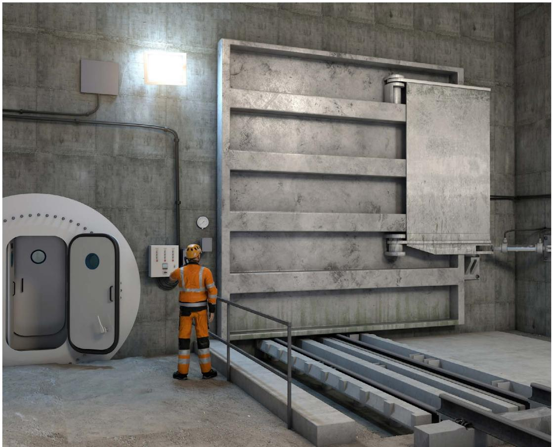
Abb. 10 Schleusentor einer Großschleuse zur Materialförderung mit Gleisbetrieb
