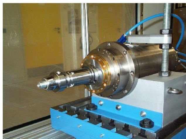
Abbildung 1 – Spindelprüfstand mit HSC-Motorspindel für die innere Aerosolzufuhr
