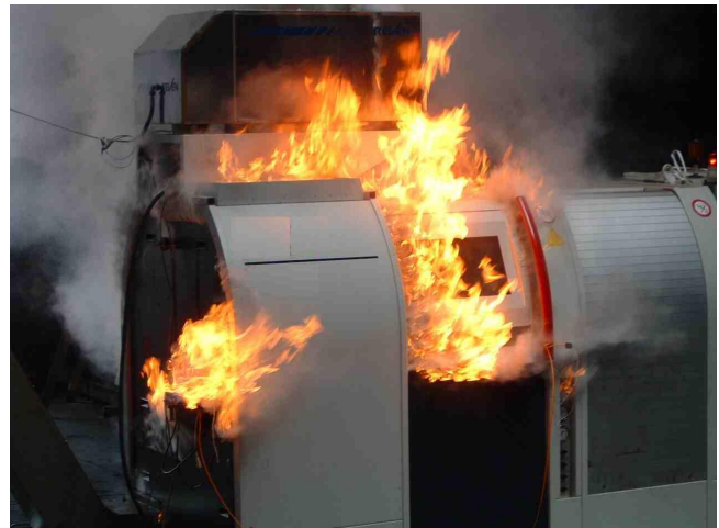
Abbildung 1 – Flammenaustritte an einer WZM nach Zündung des KSS-Luft-Gemischs [1]
