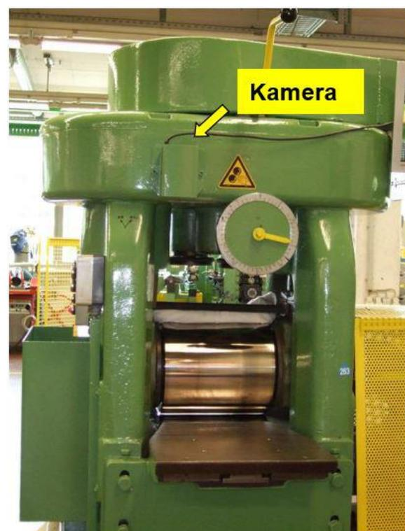
Abbildung 14 – Mit einer Kamera ausgerüstetes Walzwerk
