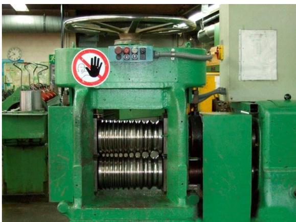
Abbildung 10 – Tippbetrieb beim Drahtwalzen
