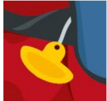
Abb. 18 Beispiel einer Reißleine für die Handauslösung der Aufblasvorrichtung
