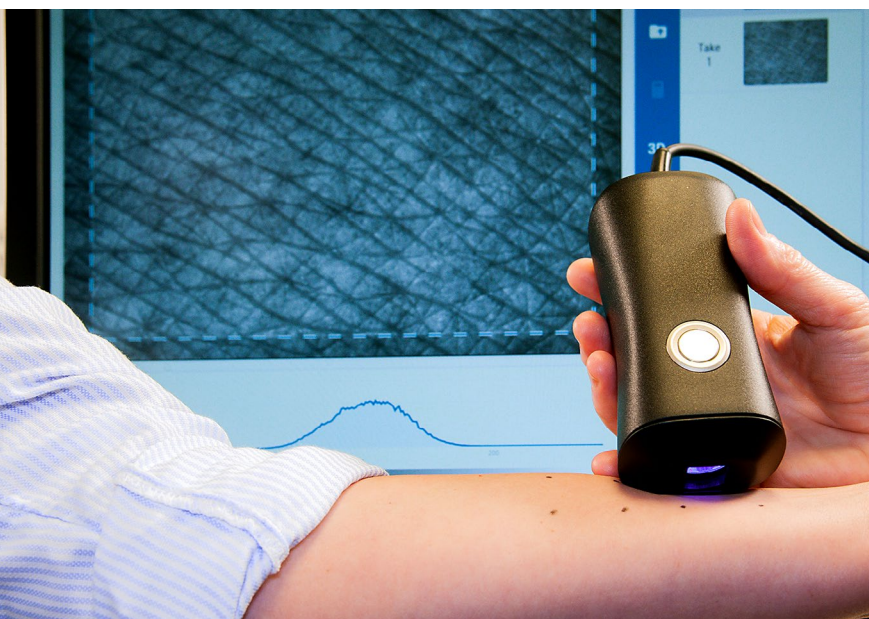
Hochauflösende UV-A-Videokamera, um die Hautoberfläche zu untersuchen. Die aufgenommenen Bilder zeigen sowohl die Struktur der Haut, als auch deren Trockenheit beziehungsweise Schuppigkeit.
