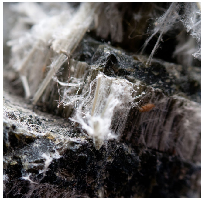
Chrysotil-Fasern machen weltweit 95 % aller Asbestfasern aus.
