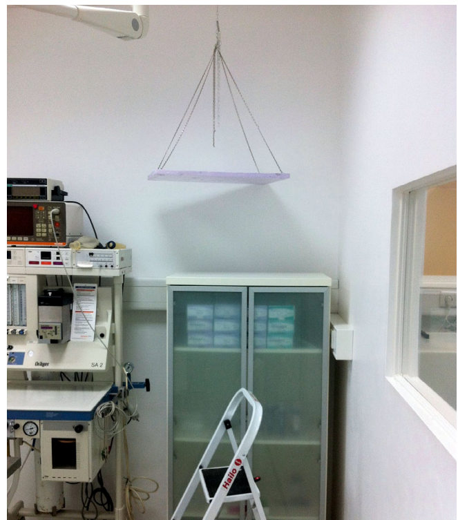
Abb. 1 Probenahme in einer Praxis durch einen Passivsammler auf einem Deckenhänger.
