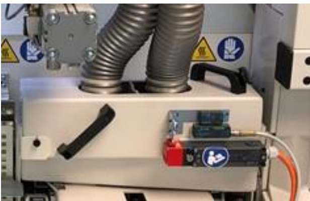
Abbildung 6 – Beispiel einer zugehaltenen Schutzeinrichtung an einem Vorfräs-/Fügeaggregat
