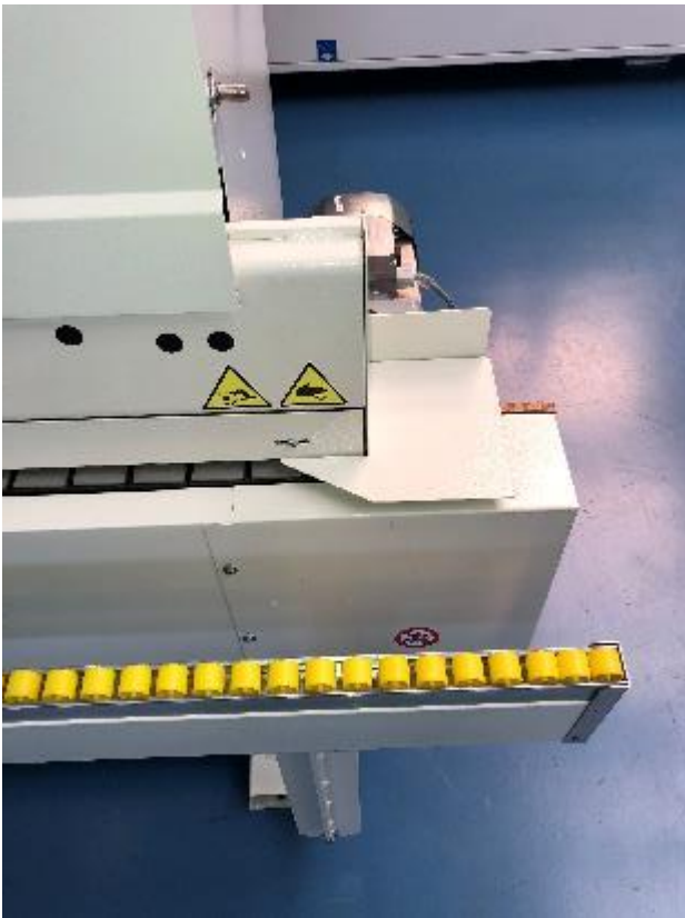
Abbildung 10 – Beispiel für abweisende und mitbewegende Schutzeinrichtung mit Spaltbegrenzung am Werkstückausschub
