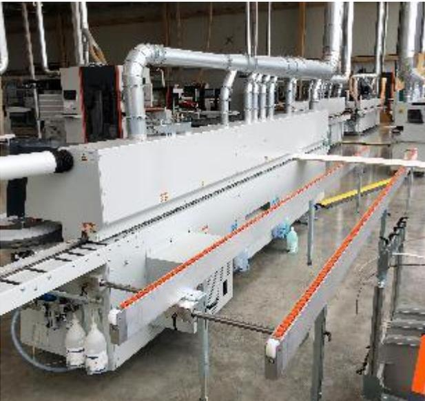
Abbildung 7 – Beispiel einer distanzierenden Schutzeinrichtung mit integrierter Werkstückauflage
