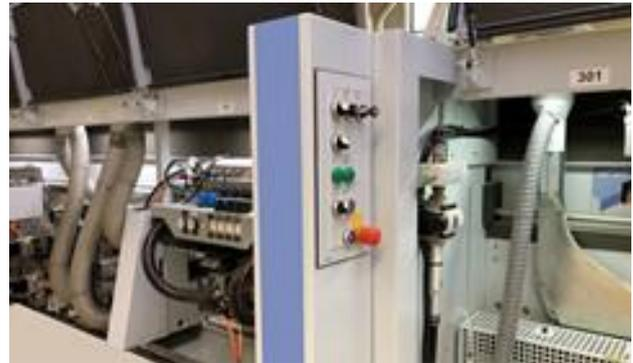
Abbildung 3 – Beispiel von Befehlseinrichtungen auf einem zusätzlichen Bedienpult
