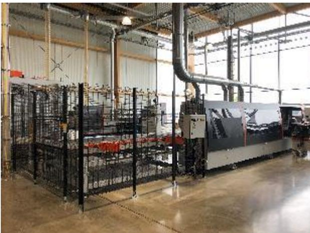
Abbildung 13 – Beispiel einer Zugangssicherung des Querschiebers am Maschinenauslauf
