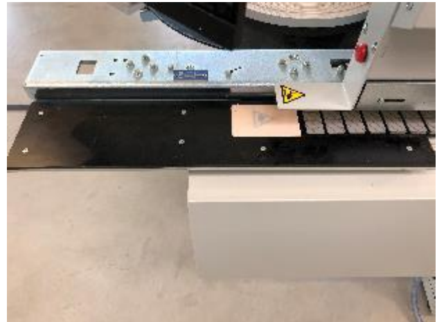
Abbildung 9 – Beispiel für eine einstellbare, abweisende und mitbewegende Schutzeinrichtung mit Spaltbegrenzung am Werkstückeinschub
