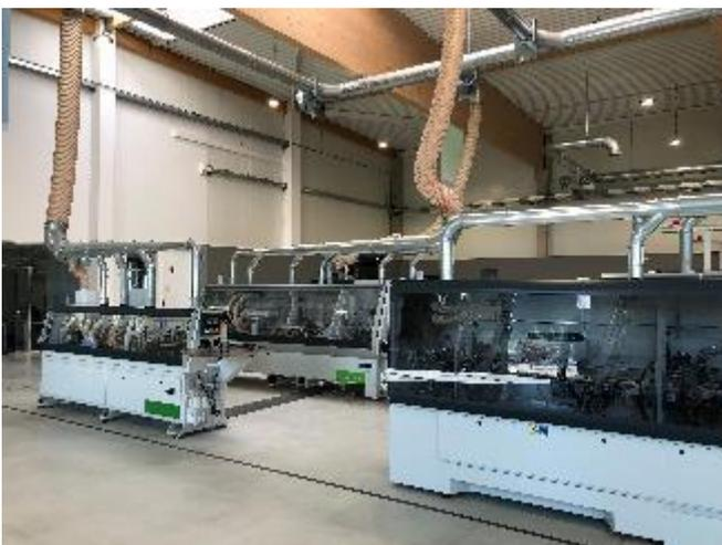
Abbildung 1 – Bauformen einseitiger Kantenanleimmaschinen
