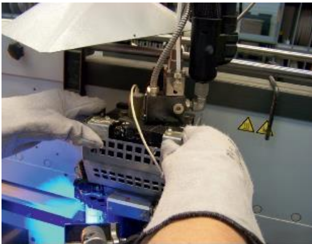
Abbildung 16 – Beispiel einer Klebstoffauftragseinheit mit Absaugung und distanzierenden Schutzeinrichtungen
