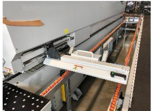
Abbildung 12 – Beispiel einer Zuführhilfe für Schmal- bzw. Kurzteile
