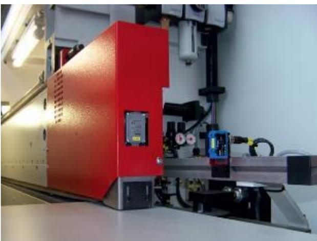
Abbildung 8 – Beispiel für eine druckempfindliche Sicherheitsschalteneinrichtung
