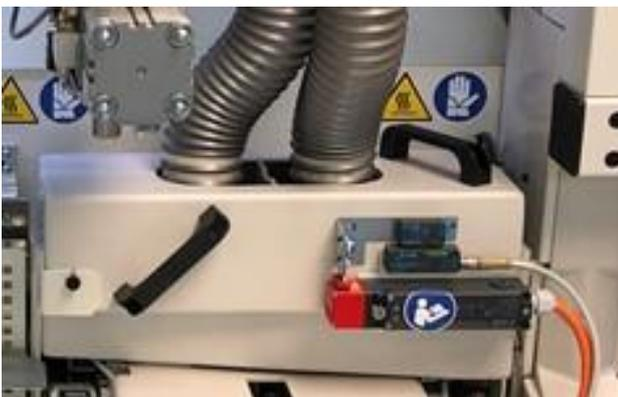
Abbildung 6 – Beispiel einer zugehaltenen Schutzeinrichtung an einem Vorfräs-/Fügeaggregat
