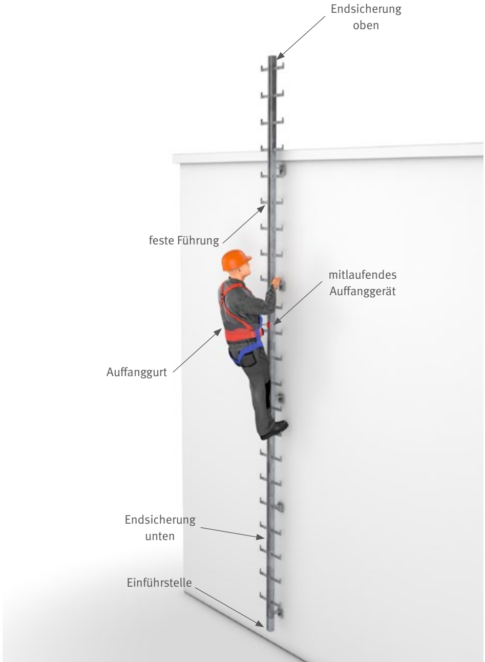
Abb. 1 Beispiel für eine Steigschutzeinrichtung
