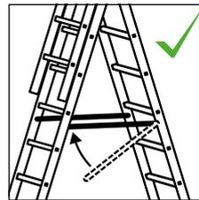
Die druckfesten Spreizsicherungen verhindern das Zusammenschieben der beiden Leiterschenkel. Spreizsicherungen dürfen nicht als Ablage verwendet oder betreten werden.
