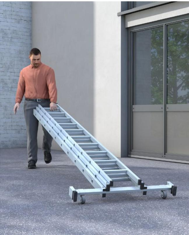
Abb. 67 Ergonomischer Transport schwerer Leitern mittels Transportrollen
