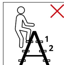
*Die beiden oberen Stufenpaare dienen dem Anlehnen und ermöglichen so einen sicheren Stand auch ohne separate Haltevorrichtung.*
