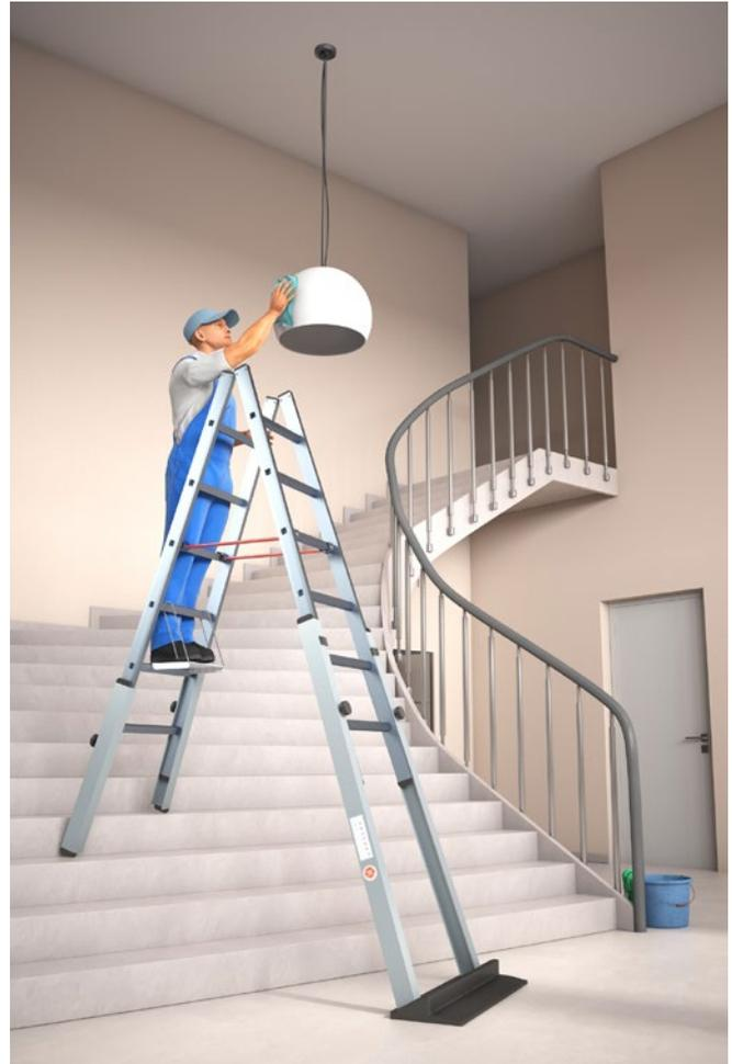
Abb. 28 Sprossenstehleiter mit Holmverlängerung und Einhängepodest
