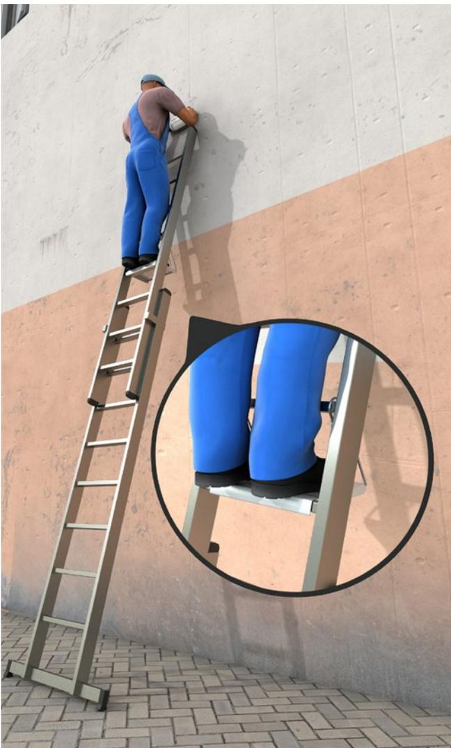
Abb. 17 Schiebeleiter mit Einhängepodest
