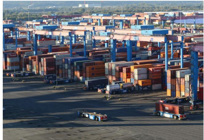
Abb. 2 Containerverladung mit fahrerlosen Transportsystemen
