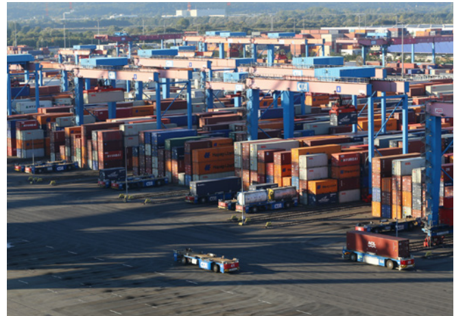
Abb. 2 Containerverladung mit fahrerlosen Transportsystemen
