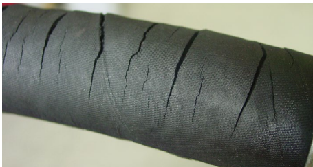
Abb. 10.1 Defekte Hydraulik-Schlauchleitungen sofort ersetzen
