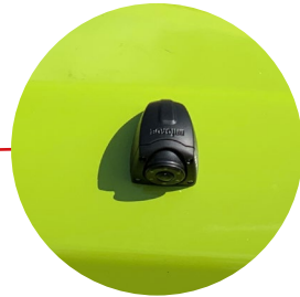
Abb. 8.5 Kamera für Sicht zur rechten Seite eines Teleskopstaplers
