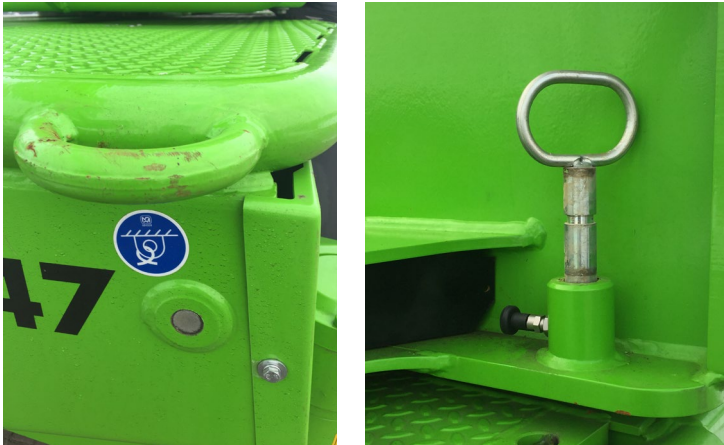
Abb. 8.9 Zurr-Öse zur Ladungssicherung (links) und Drehkranzarretierung (rechts)
