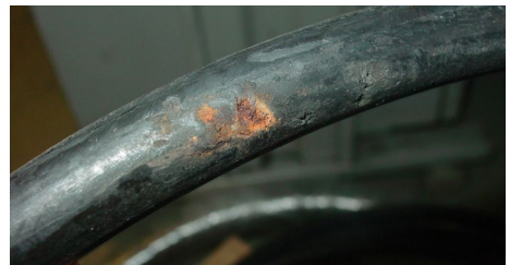
Abb. 10.1 Defekte Hydraulik-Schlauchleitungen sofort ersetzen
