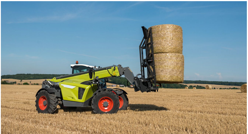
Abb. 5.5 Teleskopstapler mit Ballengreifer
