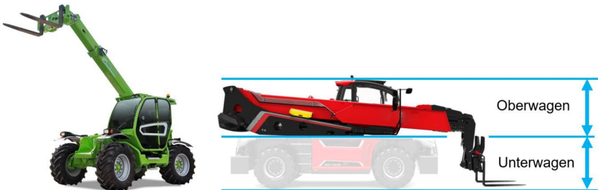
Abb. 5.1 Starrer Teleskopstapler (links), drehbarer Teleskopstapler (rechts)
