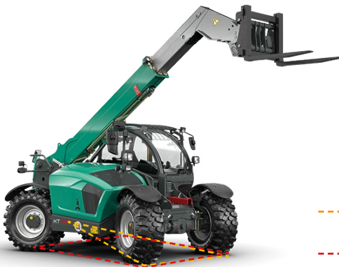
Abb. 4.1 Standsicherheitsdreieck bzw. -viereck
