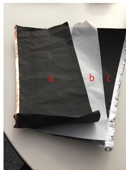
Abbildung 3 – Anoden-(a), Separator-(b), Kathoden(c)-Material
