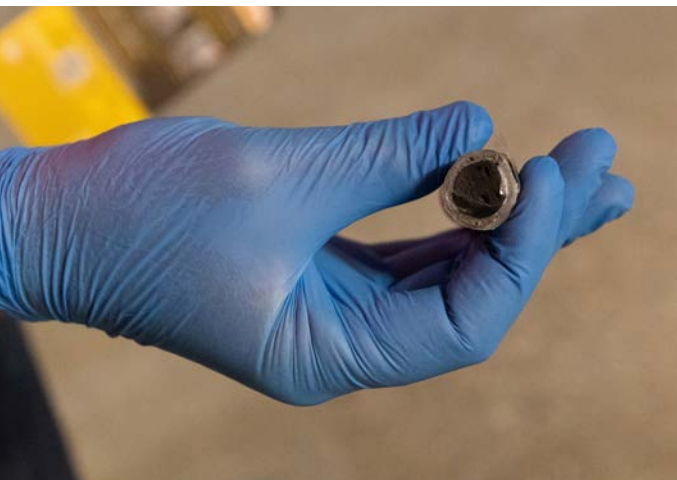
Abb. 7 Epoxidharzknetmasse; die Verarbeitung muss mit geeigneten Schutzhandschuhen erfolgen (s. Anhang 3)
