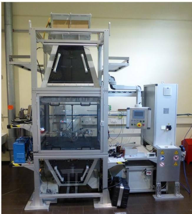
Staubtechnische Prüfkammer zum Testen von Aerosolsammlern.
