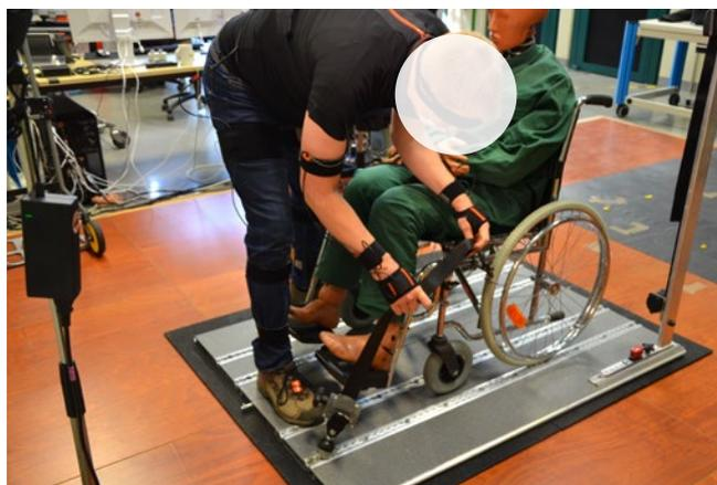
Probemessung zur Sicherung eines Rollstuhls im Fahrzeug auf einer Übungsplatte der BG Verkehr; die geplanten Versuche finden später in realen Fahrzeugen statt.
