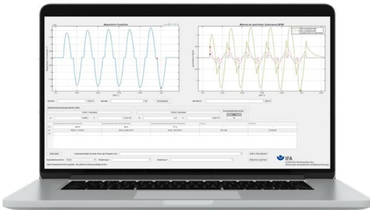
Screenshot der BEMF-Software: Aus der magnetischen Flussdichte berechnet die BEMF-Software mittels der WPM einen Expositionsindex.
