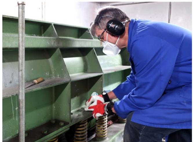
Hand-Arm-Vibration: Messungen an einer Gleitschleifmaschine.
