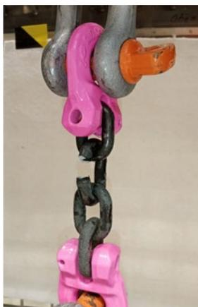
Zugversuch der Kettenglieder nach erzeugtem Bruch.
