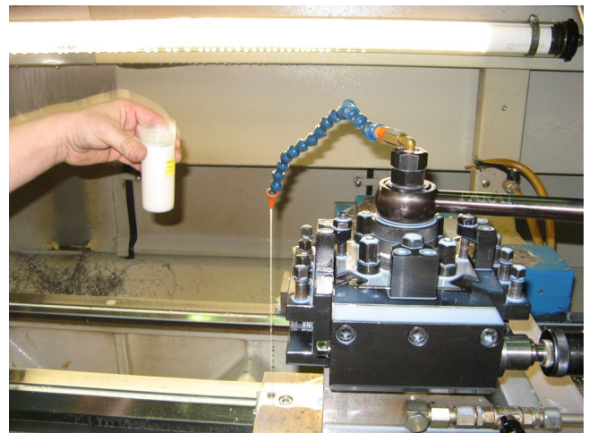
Probenahme von Kühlschmierstoffen für mikrobiologische Untersuchungen. Bild: IFA
