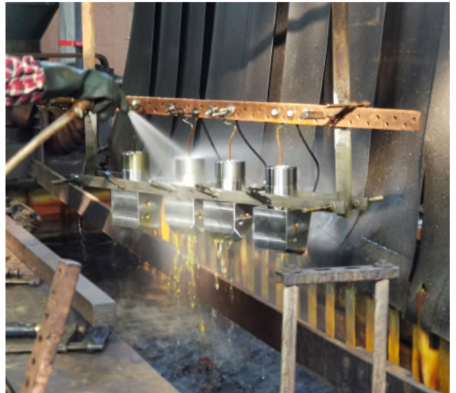
Reinigung verchromter Bauteile, unmittelbar nach der Galvanisierung
