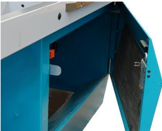
Abbildung 29 – Zugriffstür mit Positionsschalter
