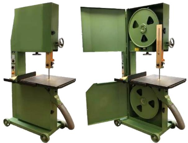
Abbildung 1– Tischbandsägemaschine
