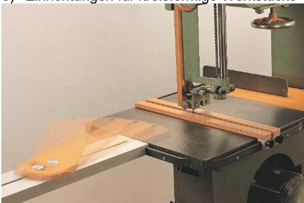
Abbildung 21 – Einrichtung für das Kreiseschneiden
