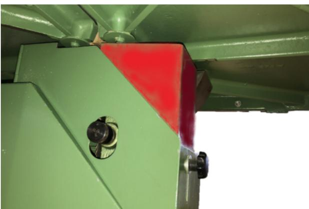
Abbildung 9 – Verkleidung unter dem Tisch bei schwenkbarem Tisch
