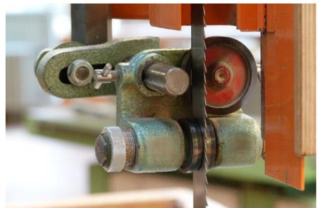
Abbildung 13 – Obere Sägeblattführung, rückseitige und seitliche Führung des Bandsägeblattes über „Rollen“
