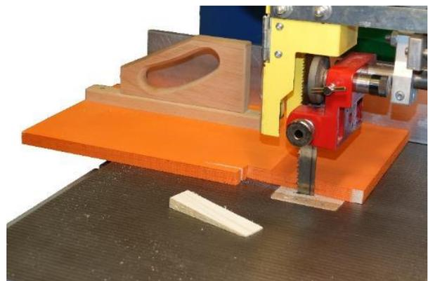
Abbildung 18 – Keilschneidlade
