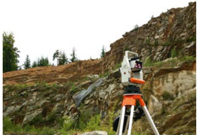
Abb. 2 3D- Laserscanner, Quelle: geokonzept
