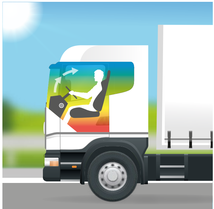
Abb. 13 Luftführung und Temperaturverteilung im Kühlbetrieb
