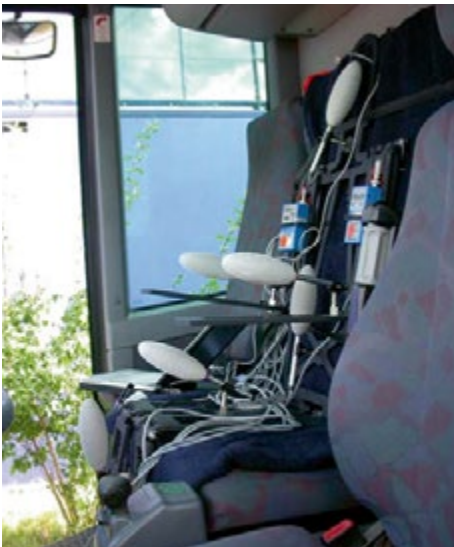
Abb. 5 Messsystem zur Klimabeurteilung auf dem Beifahrersitz - unter Einsatzbedingungen
