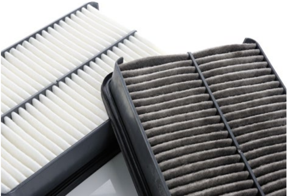
Abb. 14 Neuwertiges Filter (links) und verschmutztes Filter (rechts)
