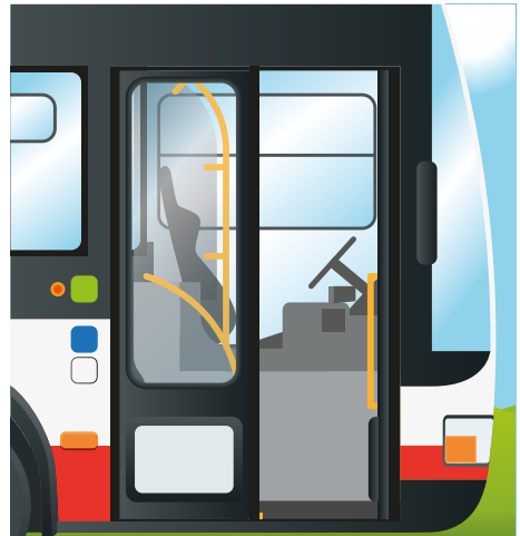
Abb. 10 Türflügelsperre: Nur eine Tür geöffnet
