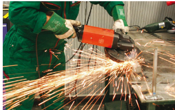
Abb. 13–14 Beispiele für Einwirkungen von Ganzkörper- und Hand-Arm-Vibrationen
