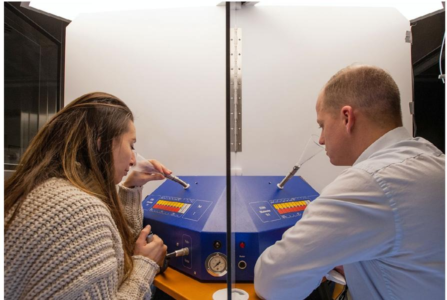
Probanden am Olfaktometer zur Ermittlung von Geruchsschwellen
