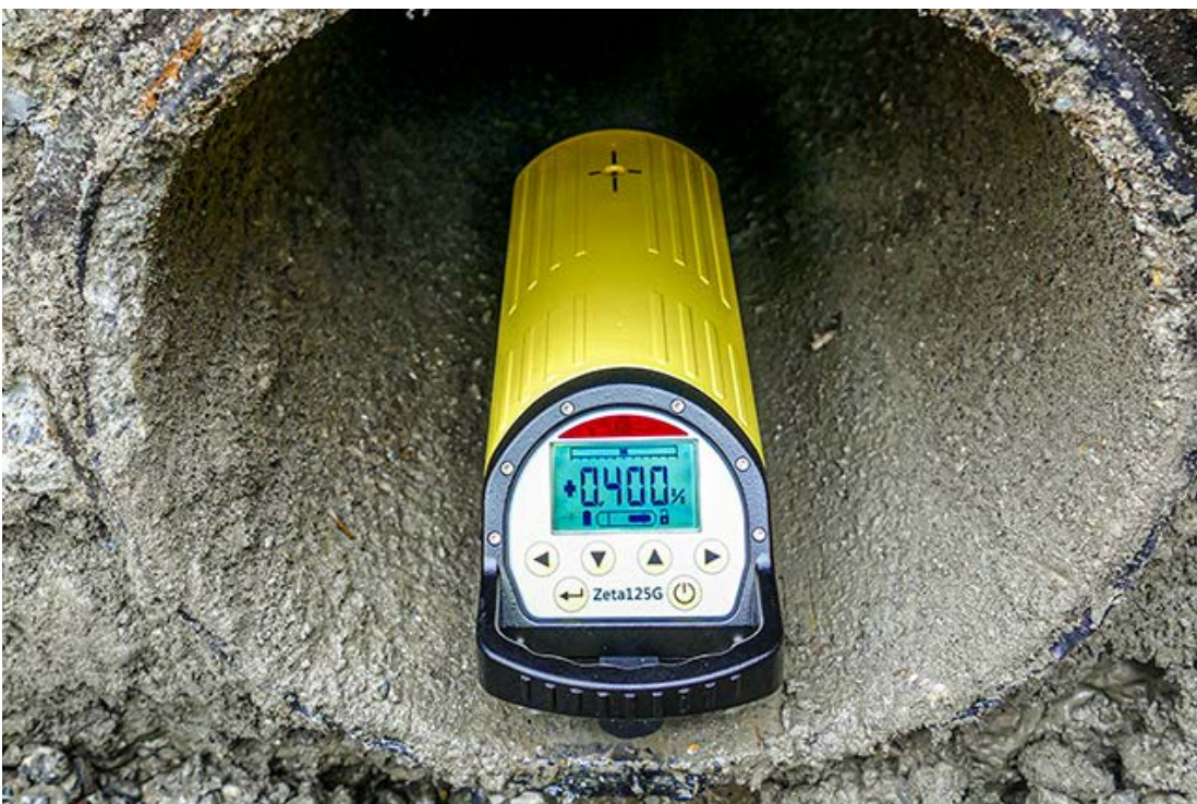
Abb. 9 Kanalbaulaser (Klasse 2M)
