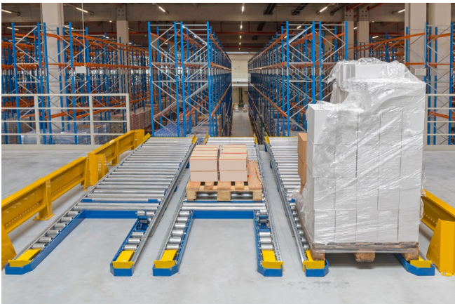
Abb. 4 Schwerkraftrollenbahnen als Puffer im Waren- ausgang
