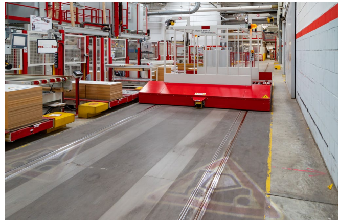
Abb. 46 Querverschiebewagen mit Laserscannern als Schutzeinrichtung
