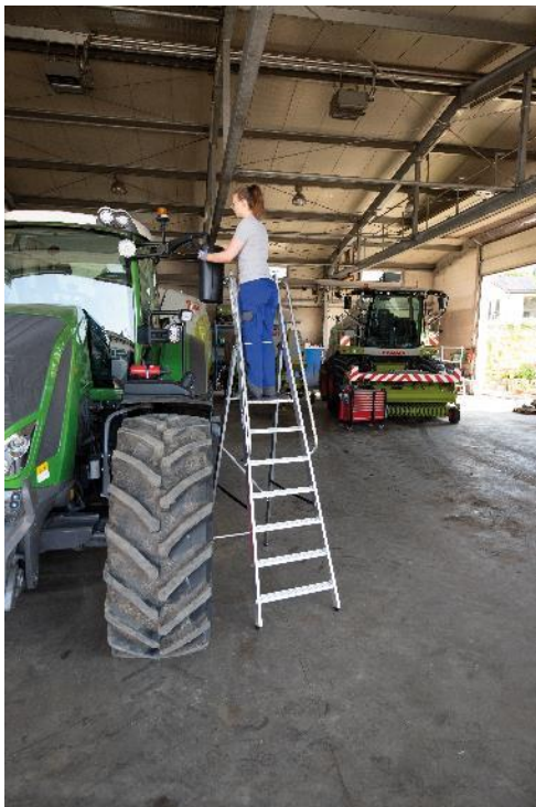
Abbildung 37 – Podest, Plattformleiter Sicherer Standplatz durch Podest/Plattform (branchenübergreifend)
