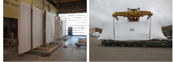
Abbildung 10a und 10b – Fertig konfektionierte Transport-/Ladegestelle Auswechselbare Transport-/Ladegestelle für Fertigteile, im Austauschverfahren eingesetzt
