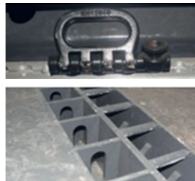
Abbildung 14a und 14b – Schwerlast-Zurrrpunkte und Rungen-Steckplätze In den Fahrzeugaufbau integrierte Bauteile, mit denen die Ladung fixiert wird oder an denen Zurrmittel oder Hilfsmittel zur Ladungssicherung befestigt werden können
