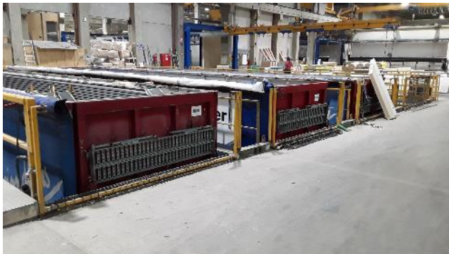
Abbildung 16 – Abgesenkte Verladestation Zugang und Beladung ohne Aufstieg möglich
