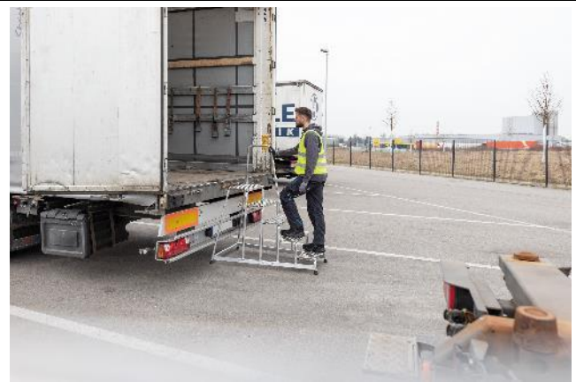
Abbildung 6 – Aufstiegstreppe/Tritt Mobile Treppe mit breiten Stufen, feststellbaren Rollen und Handlauf
