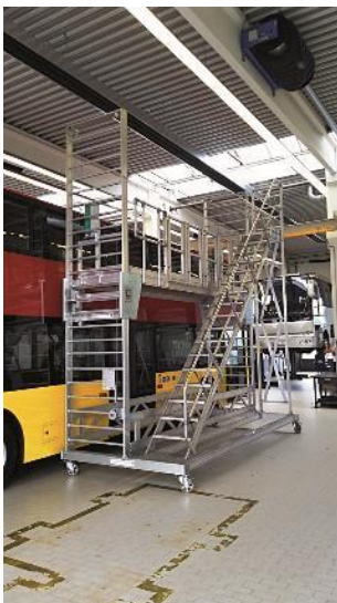
Abbildung 24 – Höhenverstellbare Dacharbeitsbühne Geländer kann über dem Fahrzeug ausgeklappt werden (branchenübergreifend).
