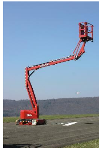
Abbildung 34 – Hubarbeitsbühne Sicherer Arbeitsplatz, verfahrbar, wirksame Absturzsicherung vorhanden
