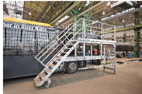
Abbildung 23 – Mobile Wartungsbühne Höhenverstellbar und mit feststellbaren Rollen (branchenübergreifend)
