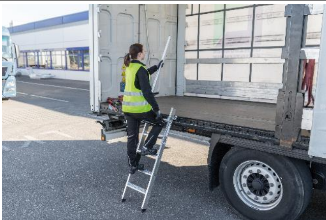
Abbildung 5 – Aufstiegsleiter Magnetisch fixiert, ausziehbarer Handlauf
