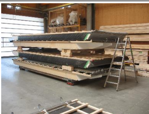
Abbildung 18 – Liegend gelagerte Bauteile Kein Aufstieg auf das Ladegut erforderlich; lange Gehänge müssen zur Verfügung stehen
