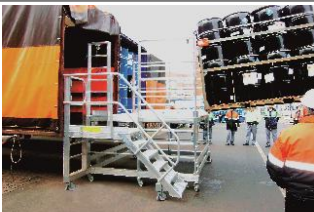
Abbildung 7 – Mobile Plattformtreppe Mobile Treppe mit breiten Stufen und Handlauf, rollbar
