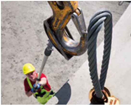
Abbildung 20 – Teleskopstangen Anschlagen vom Boden aus, verschiedene Stangenaufsätze für das An- und Abschlagen
