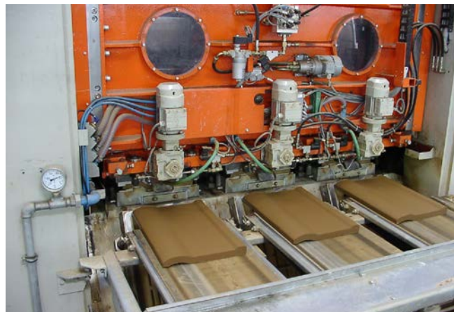
Abbildung 32: Dachpfannenziegel nach dem Pressvorgang an einer Revolver- presse. Quelle: VBG
