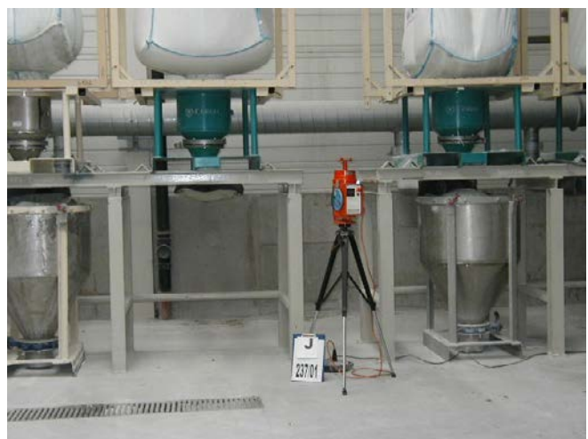
Abbildung 26: Staubarme Rohstoffaufgabe mittels Bigbag. Quelle: VBG
