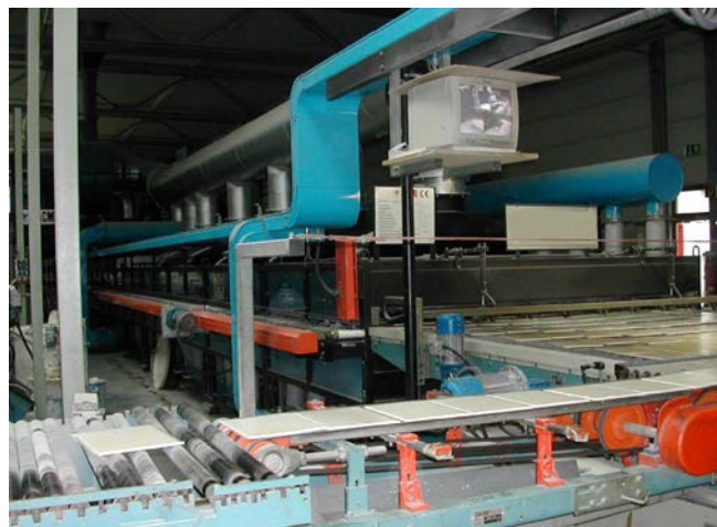
Abbildung 28: Fliesenentnahme hinter einem Schnellbrandtunnelofen. Quelle: VBG
