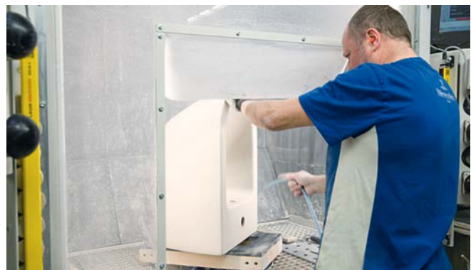
Abbildung 23: Weißputz an WC-Becken in einer Weißputzkabine. Quelle: VBG
