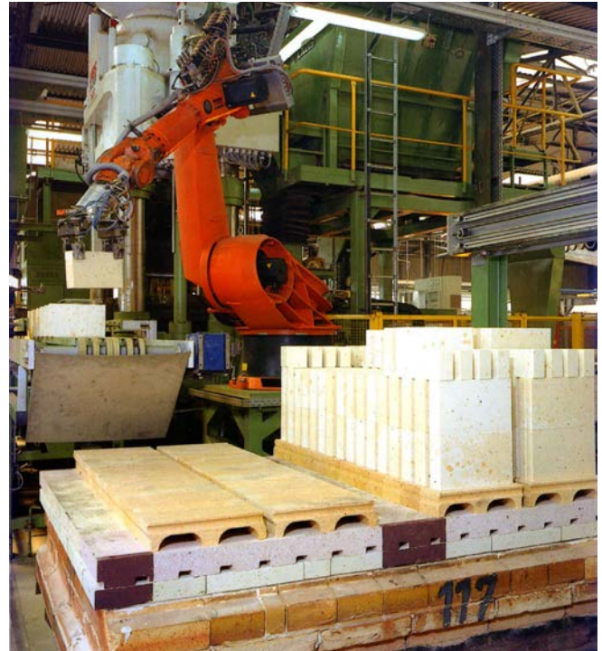
Abbildung 16: Setzen von Feuerfeststeinen auf Ofenwagen. Quelle: VBG
