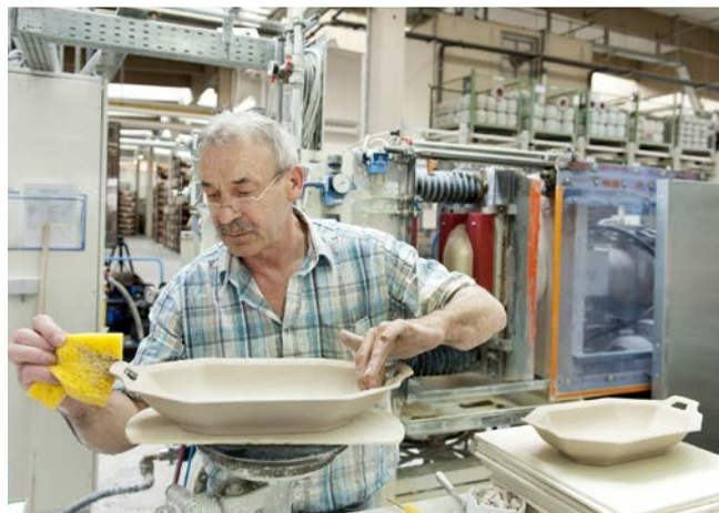
Abbildung 19: Staubarme Formgebung von Porzellangeschirr durch Druckgussverfahren. Quelle: VBG
