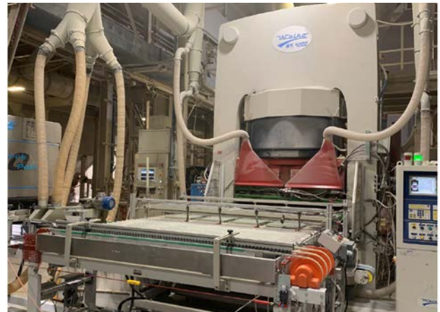
Abbildung 27: Hydraulische Fliesenpresse. Quelle: VBG
