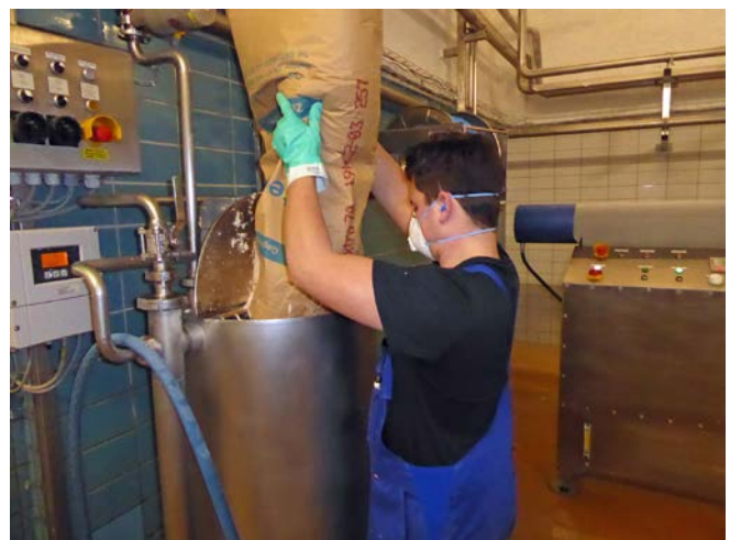
Abbildung 34: Zugabe von Filtrierhilfsmitteln bei der Getränkeherstellung. Quelle: BGN
