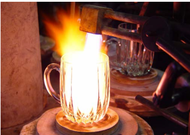
Abbildung 11: Feuerpolieren von Hohlglasartikeln. Quelle: VBG
