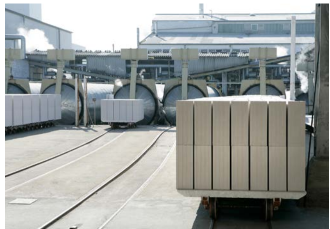
Abbildung 17: Ausfahrt von Steinhärtekesseln für Kalksandsteine. Quelle: VBG
