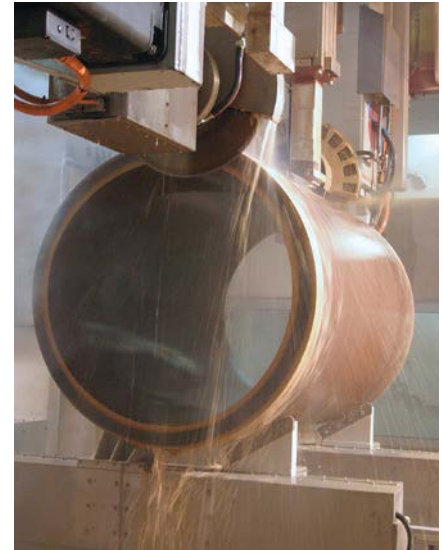
Abbildung 30: Nassschleifen von Steinzeug- rohren. Quelle: VBG
