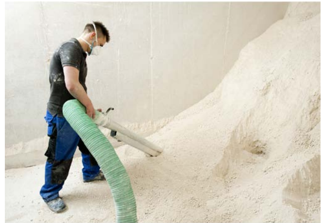
Abbildung 18: Staubarmes Entnehmen von Kaolin aus einer Materialbox mittels Saugschlauch. Quelle: VBG
