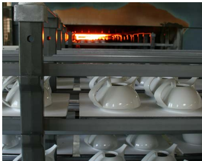
Abbildung 20: Tunnelofenausfahrt nach dem Brand. Quelle: VBG
