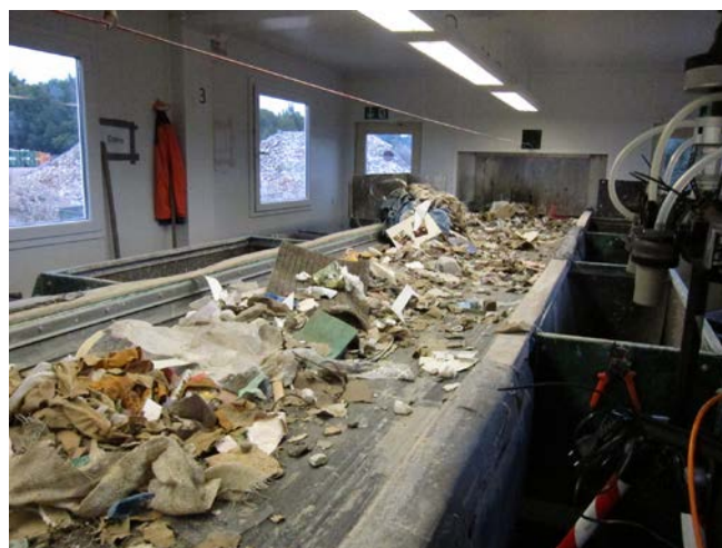
Abbildung 36: Staubmessungen an einem Sortierband beim Bauschuttrecycling. Quelle: VBG
