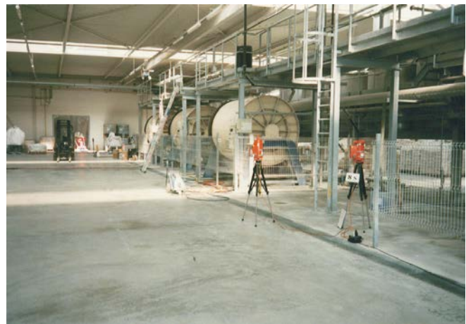
Abbildung 25: Trommelmühlen für die Rohstoffzerkleinerung in der Fliesenindustrie. Quelle: VBG
