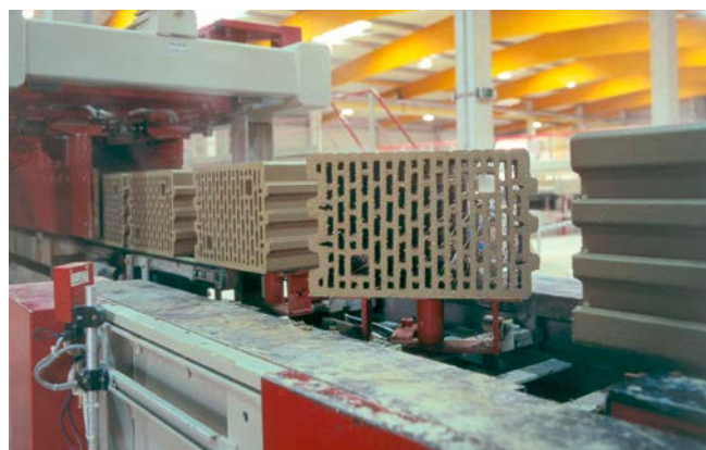
Abbildung 33: Hintermauerziegel auf einer auto- matischen Transportvorrichtung. Quelle: VBG
