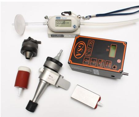
System für die personengetragene Probenahme von Aerosolen
