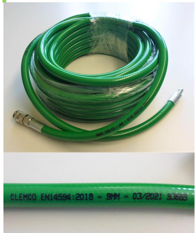
Abbildung 2 – Druckluftzuführungsschlauch – im Detailbild ist die Aufschrift dargestellt
