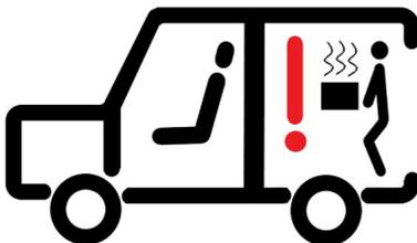
Abb. 6 Fahrzeug, bei dem Fahrerhaus und Laderaum getrennt sind und bei dem der Laderaum von außen begangen wird.
