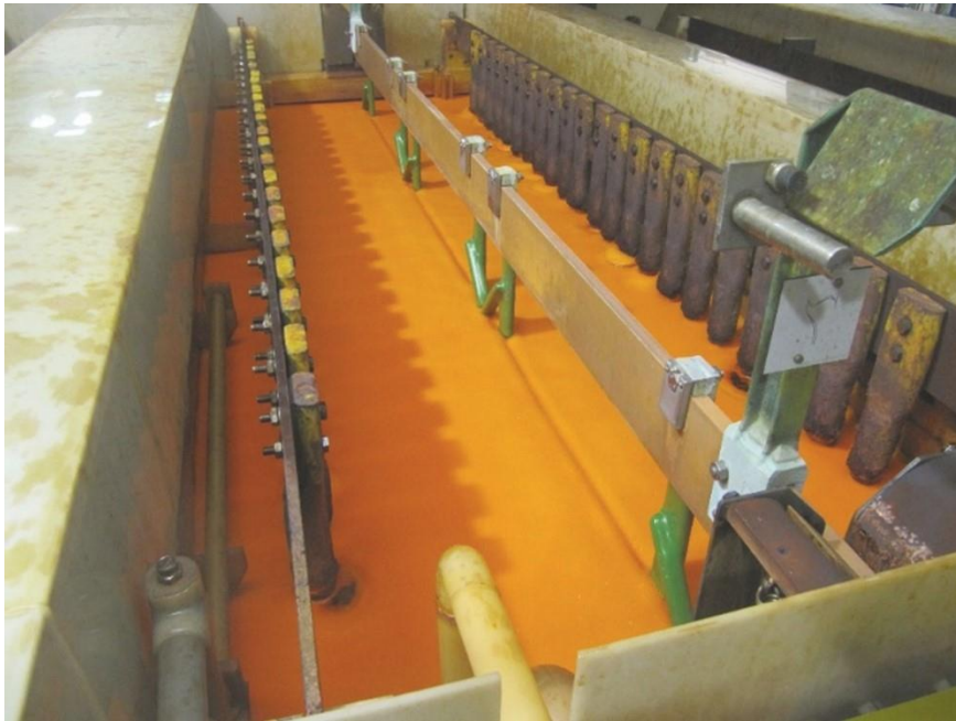
Abbildung 10 – Verchromungsprozessbehälter mit Netzmittel auf dem Elektrolyten.
