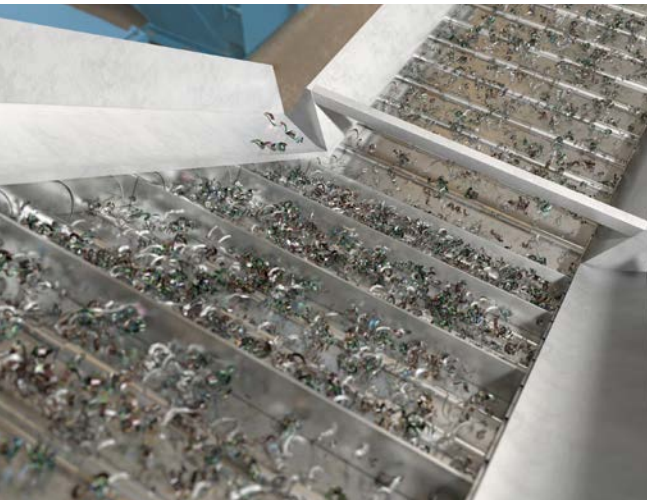
Abb. 3 Scharnierbandförderer als Späneförderer
