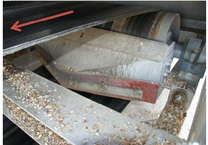
Abb. 18 Sicherung der Umkehrtrommel mit einem Füllstück, das gleichzeitig als Pflugabstreifer dient
