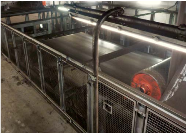
Abb. 16 Schutz der Auflaufstellen einer Spannstation durch trennende Schutzeinrichtung (Zaun mit elektrisch verriegelter Zugangstür mit Zuhaltung)
