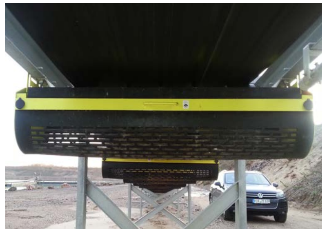
Abb. 21 Schutzkorb als feststehende trennende Schutz-einrichtung für Untergurtrollen
