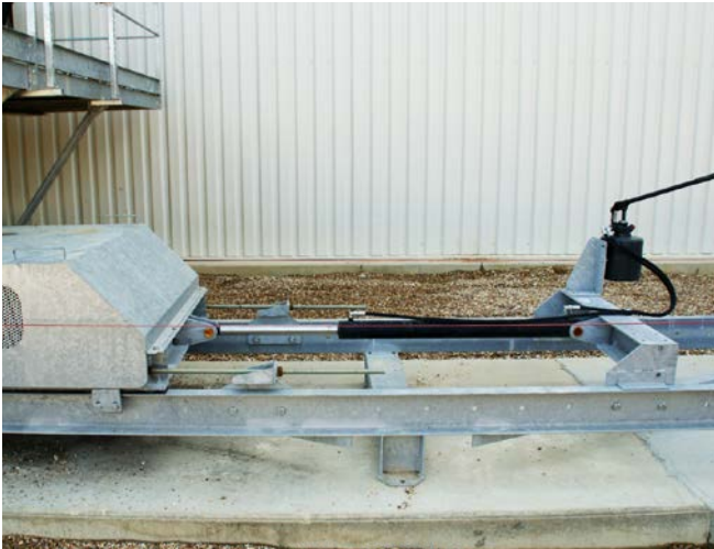
Abb. 22 Spanneinrichtung mit Verstellmöglichkeit von außen
