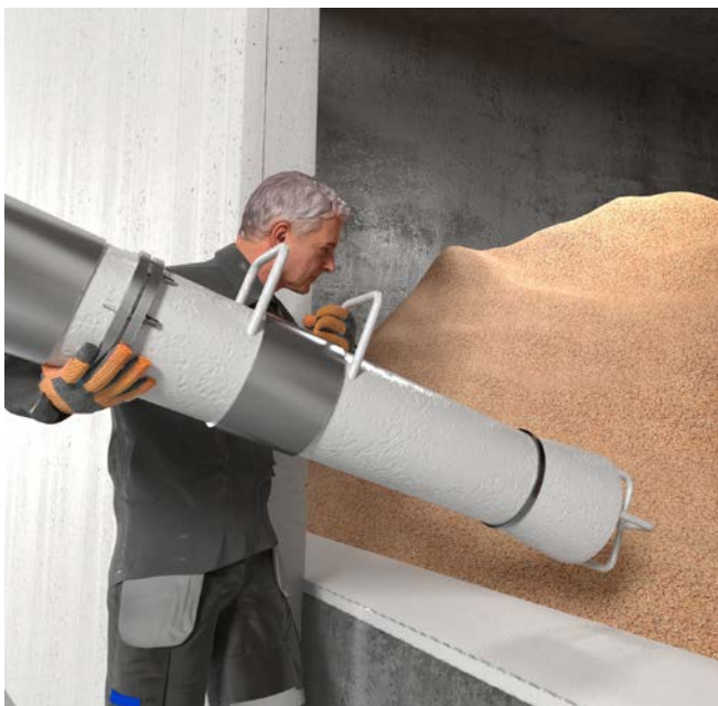
Abb. 37 Einlassöffnung eines Saugrohres durch Stäbe begrenzt
