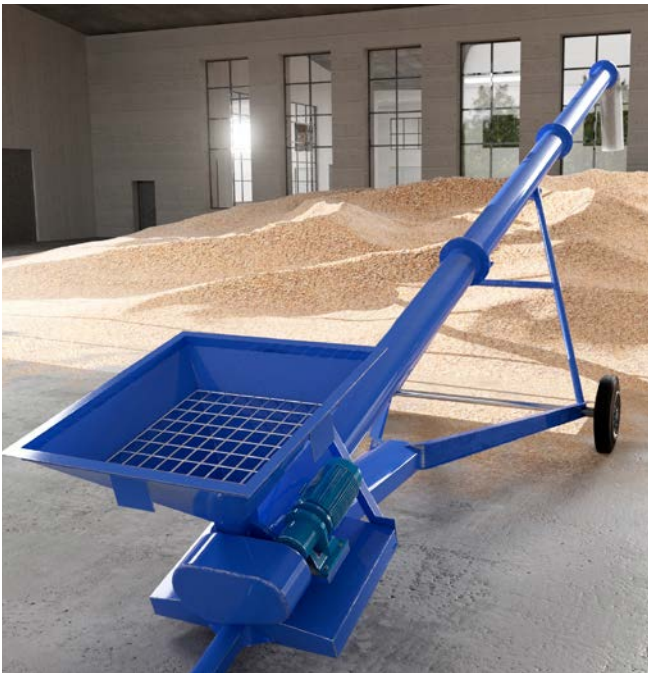
Abb. 36 Schneckenförderer für Getreide; Eingriff in Gefahrstelle durch Gitter verhindert
