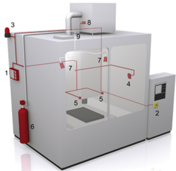
Abbildung 1 – Feuerlöschanlage in einer Werkzeugmaschine
