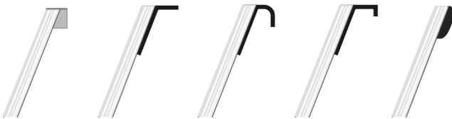
Abb. 16b Aufsetz-, Einhak- und Einhängenvorrichtungen
