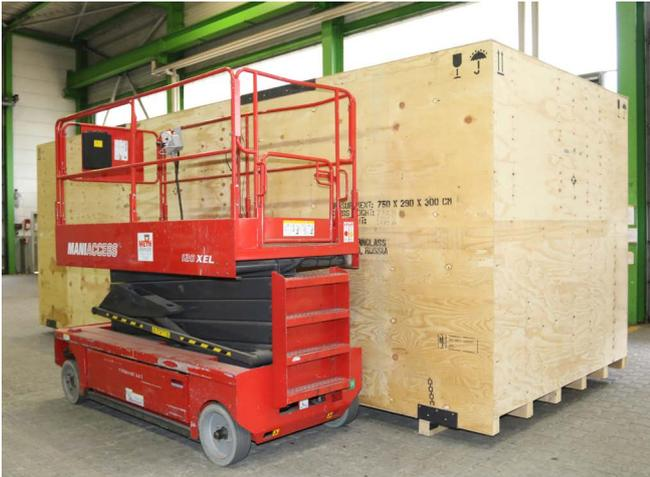
Abb. 7 Fahrbare Hubarbeitsbühne an einer Exportverpackung
