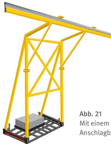
Abb. 21 Mit einem Gewicht gekonterte Anschlagbrücke
