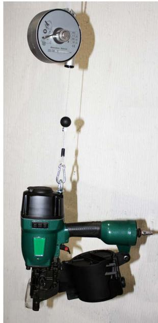
Abb. 29 Eintreibgerät mit Balancer
