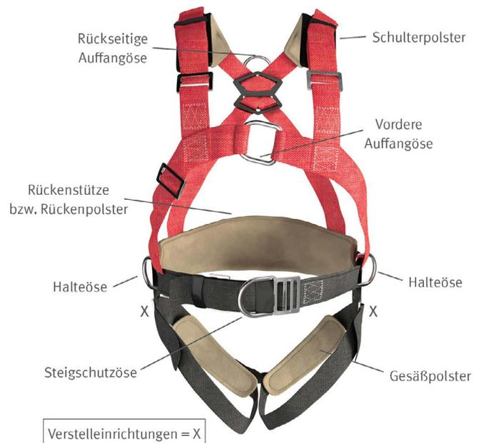
Abb. 6 Beispiel eines Auffanggurts mit vorderer und rückseitiger Auffangöse, seitlichen Halteösen und einer Steigschutzöse. Der Gurt ist zusätzlich mit Schulter-, Beingurt- und Rückenpolstern ausgestattet.
