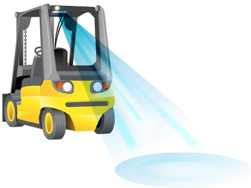
Abb. 37 Flurförderzeug mit optischer Fahrweg-Warneinrichtung
