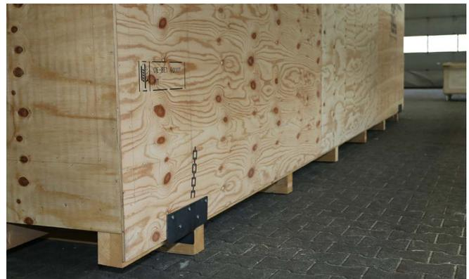
Abb. 48 Anschlagpunkte an der Exportverpackung
