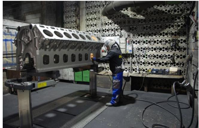
Abb. 12 Putzen eines Motorblocks
