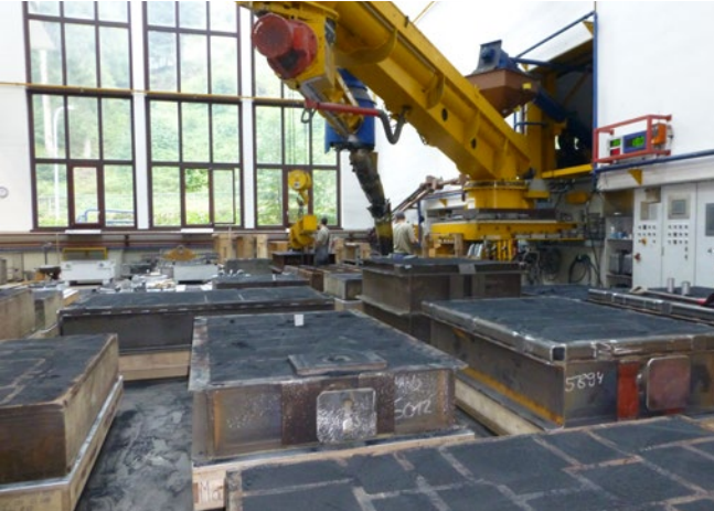
Abb. 10 Formanlage mit vorgeschalteten Formstoffmischer
