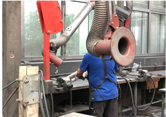
Abb. 25 Handgeführte Absaugvorrichtung beim Gussputzen
