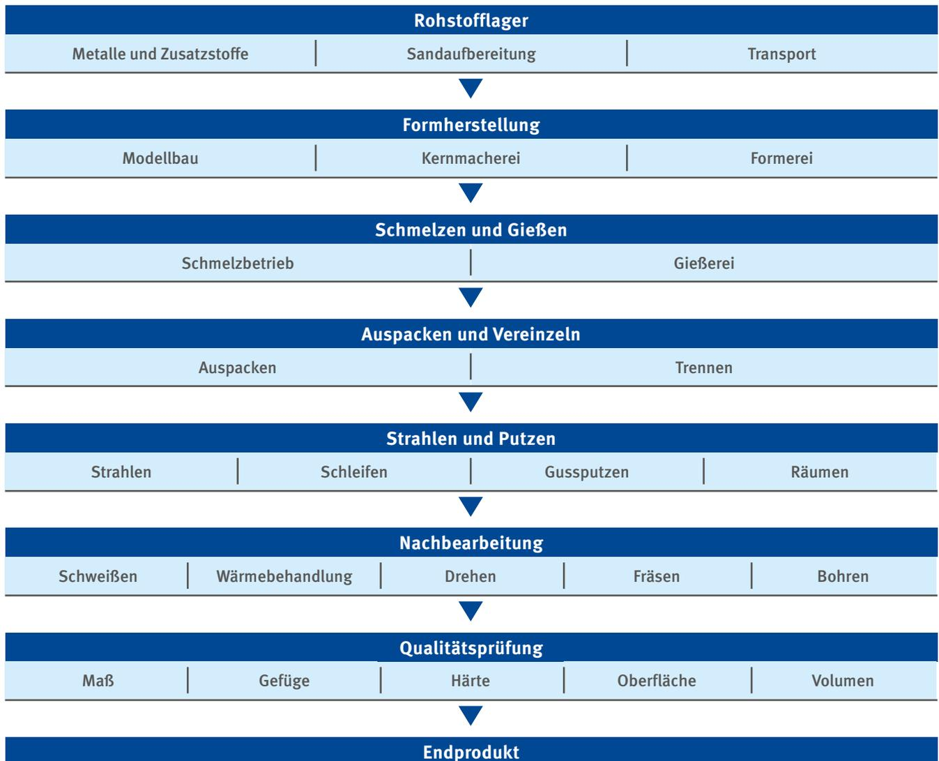
Abb. 1 Prozessschritte bei der Herstellung von Gussprodukten
