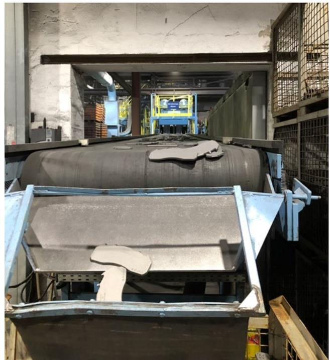
Abb. 24 Automatisierte Durchlauf-Strahlanlage
