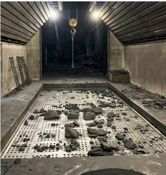
Abb. 7 Komplette eingehauste Auspackstation für große Gussstücke
