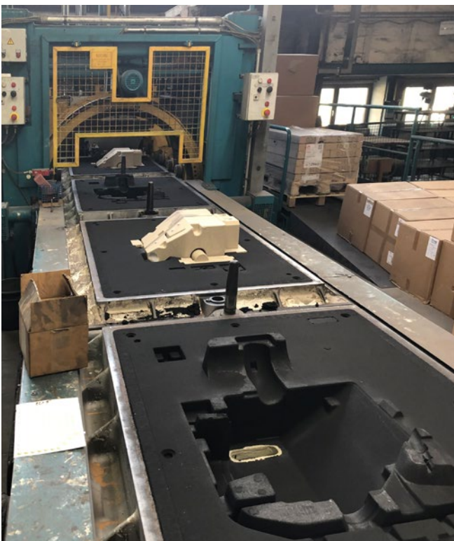
Abb. 3 Formhälften mit eingelegten Kernen
