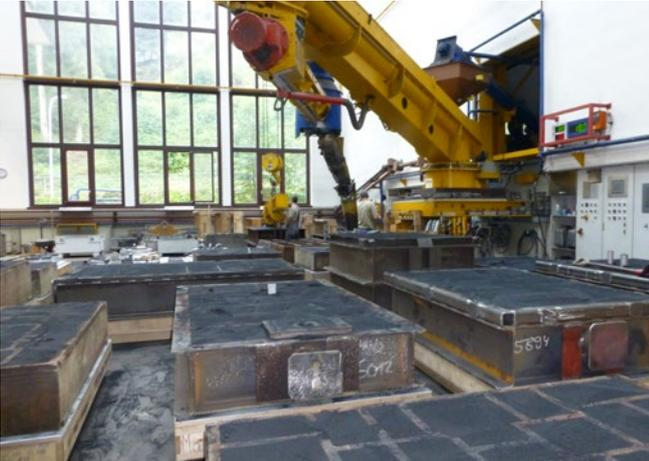
Abb. 10 Formanlage mit vorgeschalteten Formstoffmischer
