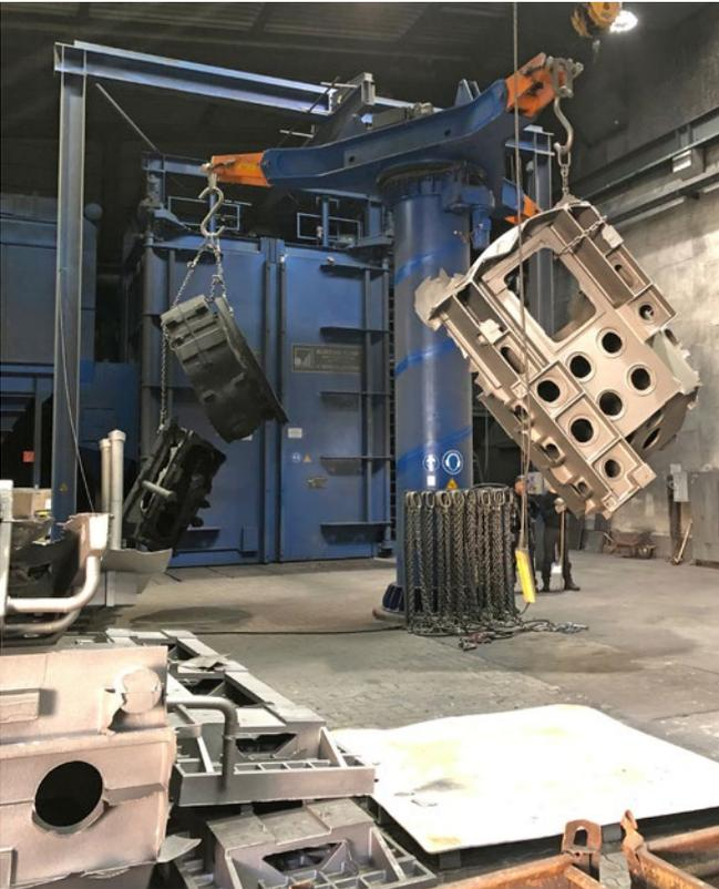
Abb. 8 Strahlen großer Gussteile
