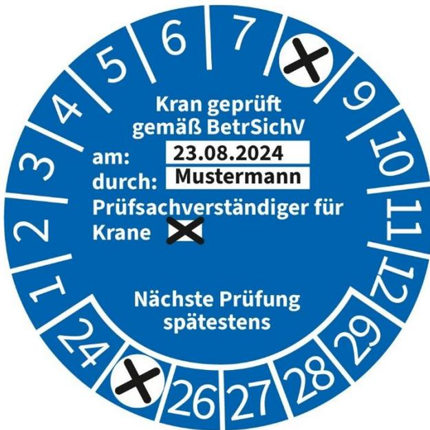
Abbildung 2 – Prüfplakette (Muster); nächste Prüfung 08/2025
