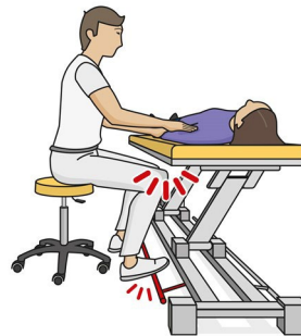
Abbildung 1: Einklemmung zwischen Liegenrahmen und Bedienelement. Bild: BGW/Schierriger
