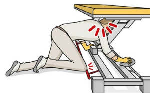
Abbildung 2: Einklemmung im Hubmechanismus der Liege. Bild: BGW/Schierriger
