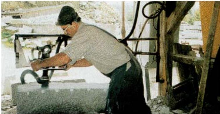
**Abb. 23: Staubabsaugung direkt an der Bearbeitungsstelle**
