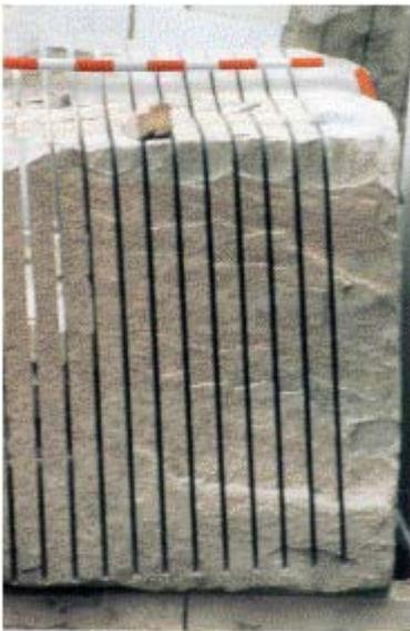
**Abb. 9: Mit Haltebügel gesicherte Steinplatten**
