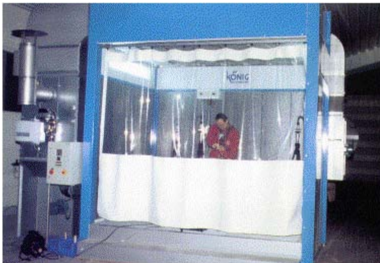
Abb. 27: Arbeitsschutzkabine mit Staubabsaugung
