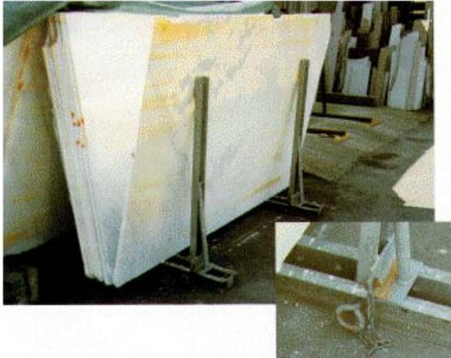
**Abb. 15: Hilfstützen am A-Bock-Lager**
