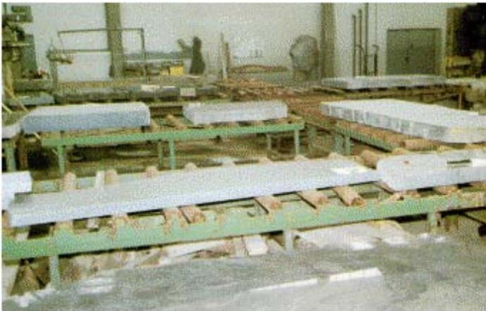
**Abb. 22: Rollenbahnen für Zwischentransporte**
