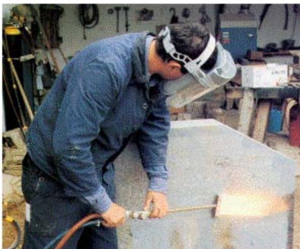
**Abb. 28: Gebläseunterstützte Atem-Schutzmaske beim Flämmen**
