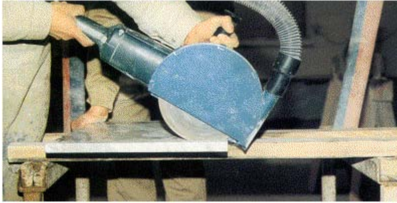
Abb. 25: Winkelschleifer mit Trennscheibe und direkter Absaugung
