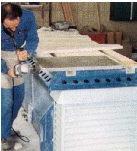
Abb. 32: Schleifarbeiten am Absaugtisch
