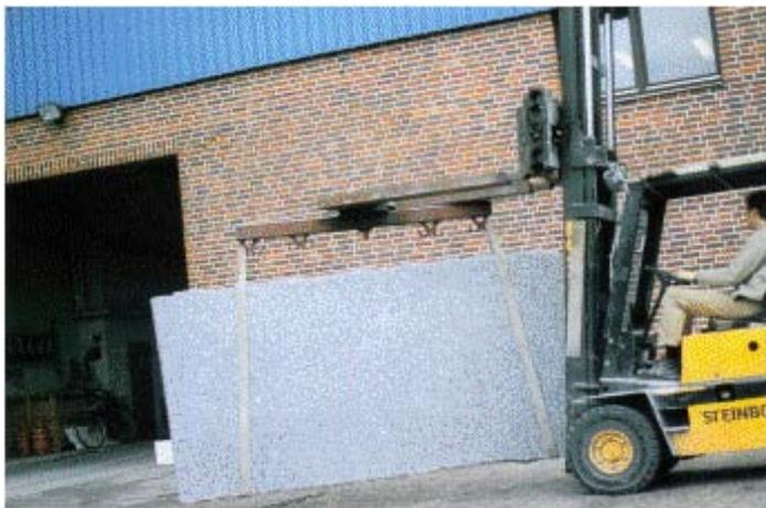
**Abb. 18: Plattentransport mit Stapler und Hebebändern**
