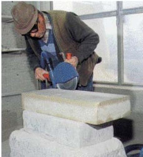
**Abb. 30: Trennscheibe mit Absaugeinrichtung**
