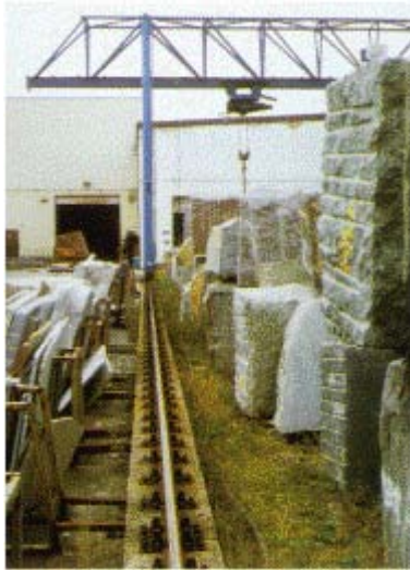
Abb. 7: Abstand zwischen Portalstütze eines Brückenkranes und den gelagerten Blöcken
