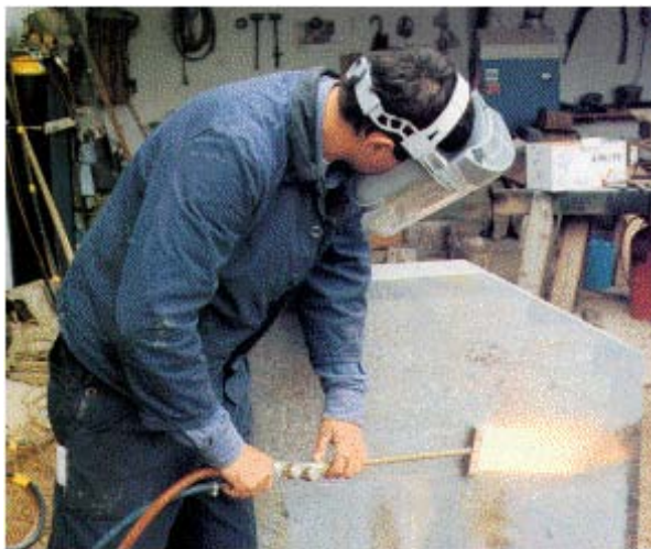
Abb. 28: Gebläseunterstützte Atem-Schutzmaske beim Flämmen
