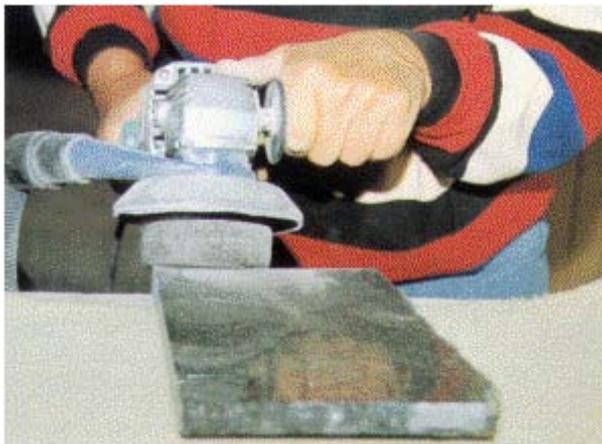
**Abb. 31: Winkelschleifer mit Absaughaube**
