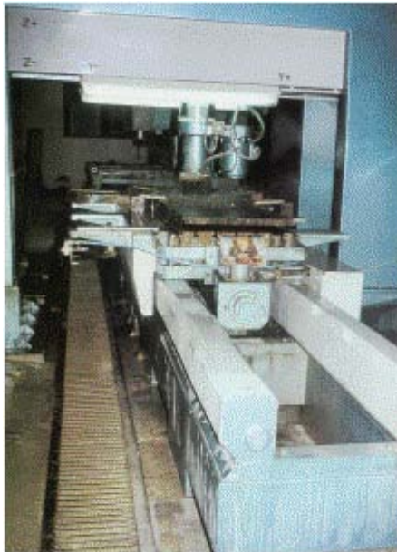
Abb. 6: Trittsicher abgedeckte Wassersammelrinne
