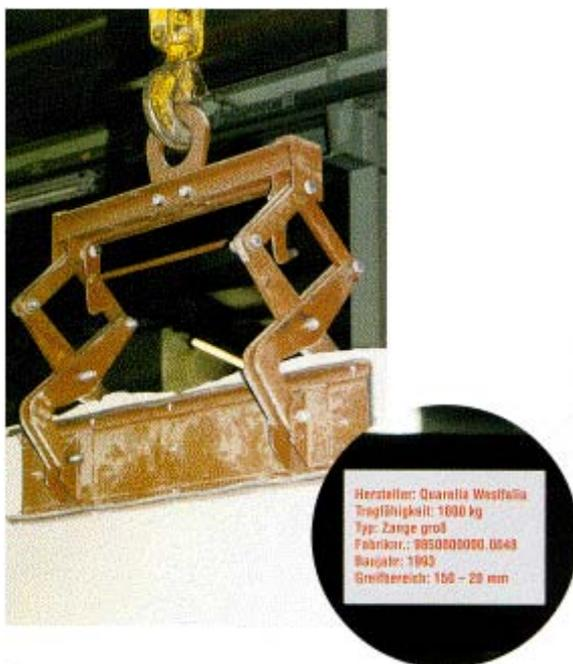
**Abb. 14:** Plattenzange mit Kennzeichnung
