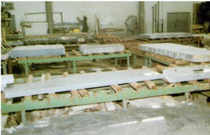
Abb. 22: Rollenbahnen für Zwischentransporte
