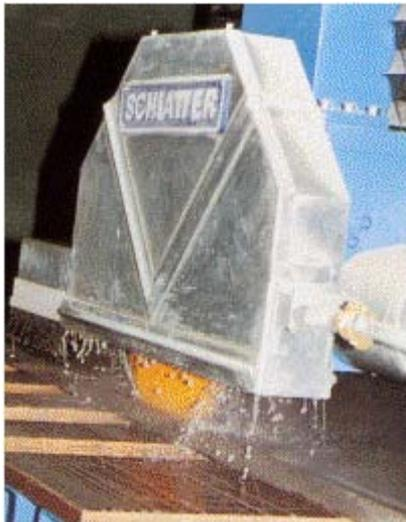
**Abb. 36: Schutzhaube und Spritzschutz an einer Brückensäge**
