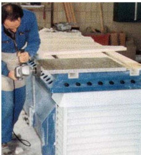
**Abb. 32: Schleifarbeiten am Absaugtisch**
