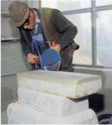
Abb. 30: Trennscheibe mit Absaugeinrichtung
