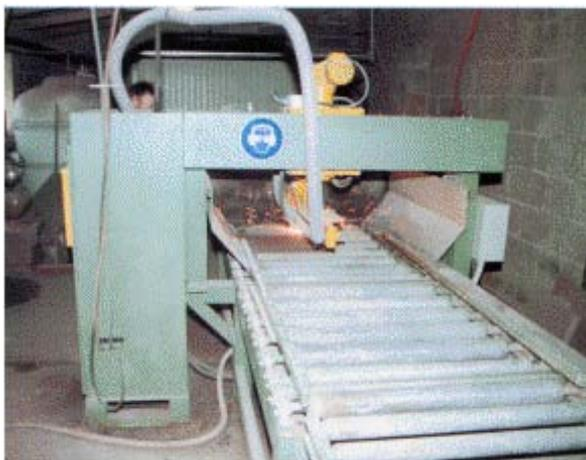
**Abb. 38: Flämmanlage zur Oberflächenbearbeitung**
