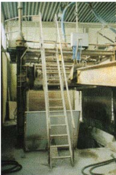
Abb. 5: Treppenaufgang zur Wartungsbühne einer Steinsäge
