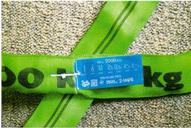
Abb. 19: Tragfähigkeitsangabe an Hebebändern durch eingenähtes Etikett
