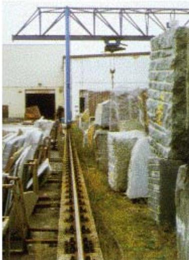
**Abb. 7: Abstand zwischen Portalstütze eines Brückenkranes und den gelagerten Blöcken**
