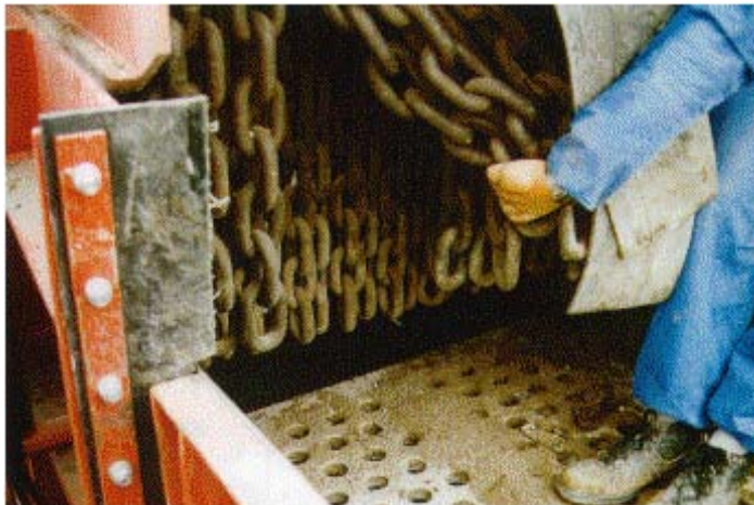
Abb. 16: Kettenvorhang zum Schutz gegen zurückschleudernde Teile
