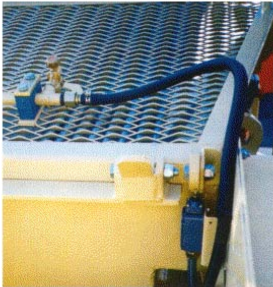
Abb. 15: Elektrisch verriegeltes Schutzgitter am Einlauf eines Backenbrechers mit Bedüsungseinrichtung
