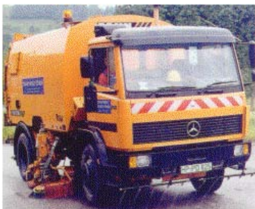
Abb. 8: Befeuchtung von Fahrstraßen durch Reinigungsfahrzeug mit Wassertank
