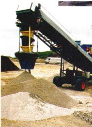
Abb. 10: Staubschutz durch Verminderung der Fallhöhe
