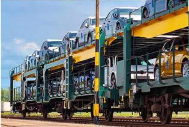
Abbildung 1: offener Autotransportwagen mit zwei Ladeebenen
