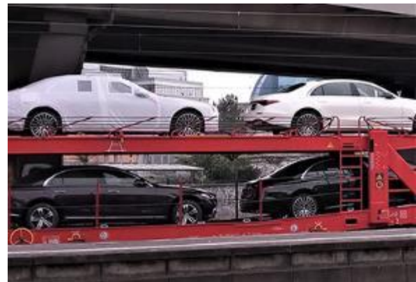
Abbildung 4: Autotransportwagen mit heruntergeklappter Absturzsicherung während der Fahrt
