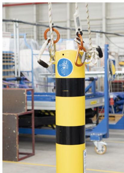
Abb. 23 Sammelpunkt für Anschlagmittel
