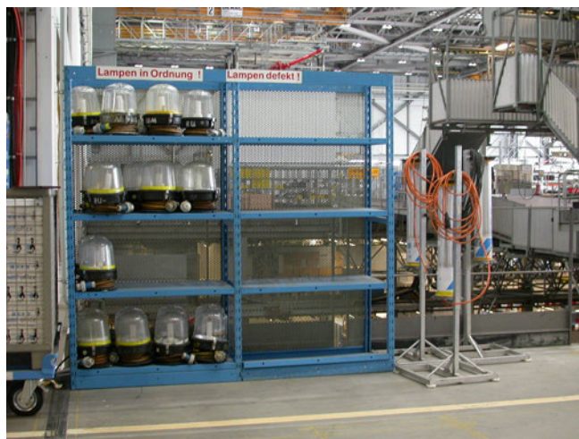
Abb. 13 Achten Sie auf getrennte Lagerung von einsatzbereiten und defekten Arbeitsmitteln
