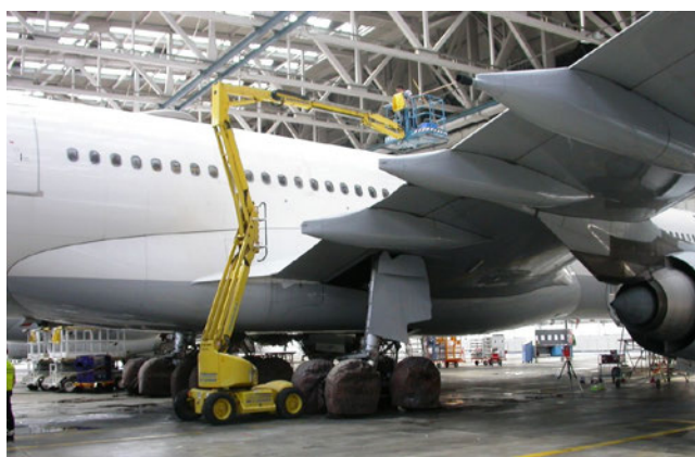
Abb. 32 Schwer erreichbare Arbeitsplätze lassen sich mit mobilen Hubarbeitsbühnen besser anfahren
