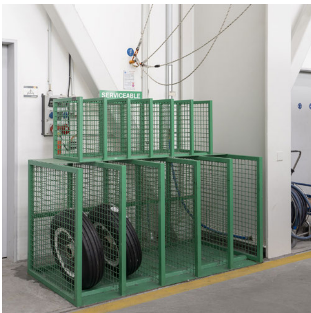
Abb. 76 Richtige Lagerung von einsatzbereiten...
