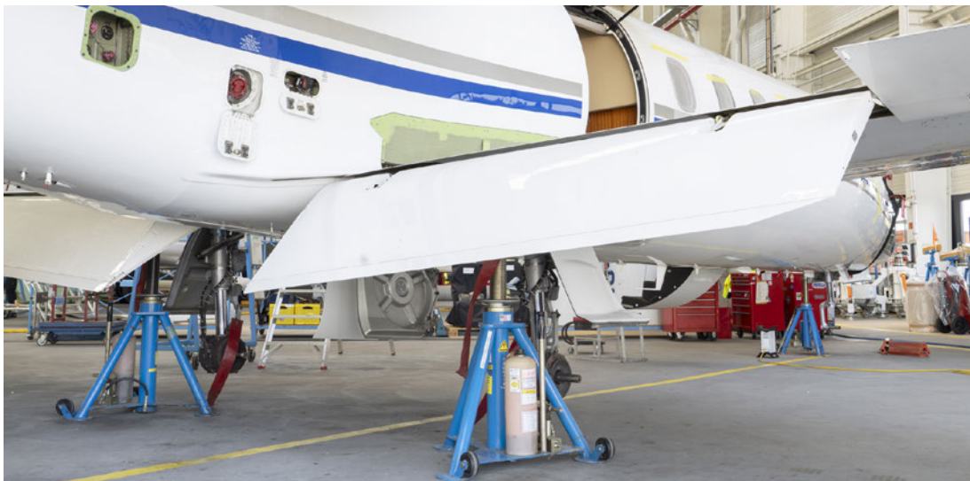
Abb. 69 Nur das gleichmäßige Anheben des Luftfahrzeugs ermöglicht sichere Instandhaltungsarbeiten
