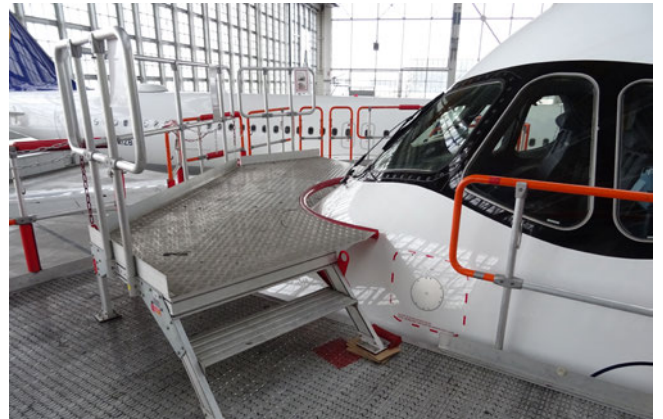
Abb. 35 Absturzsicherung zur Montage oder Reparatur der Cockpitscheiben
