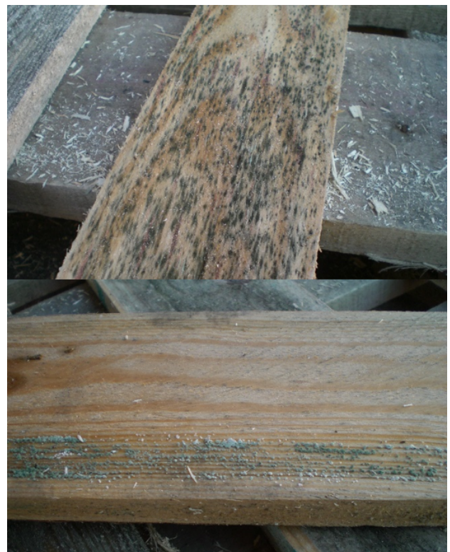
Abbildung 1– Schimmelpilzbefall an Hölzern für Transport- und Verpackungsmaterial
