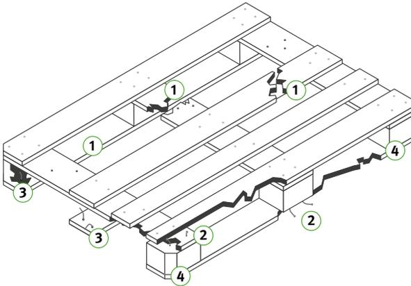
Abb. 13 Schäden oder Mängel an Flachpaletten nach UIC 435-4
