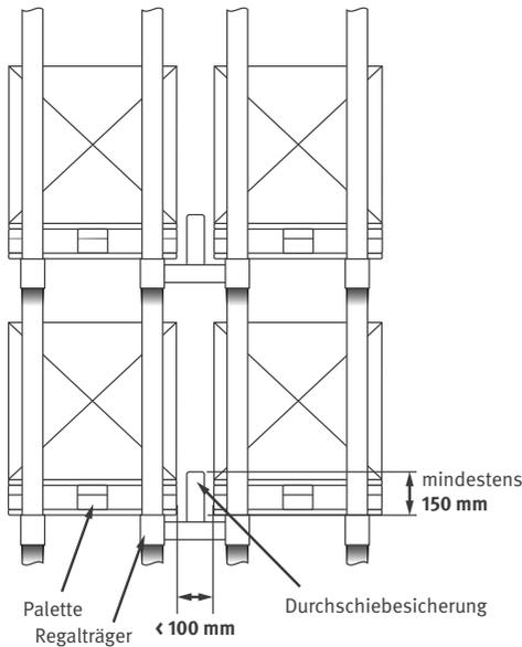
Abb. 7a Durchschiebesicherung
